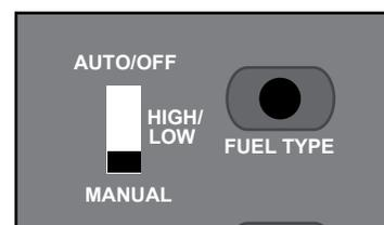
Figure 3 : Interrupteur thermostatique en mode "MANUEL"
