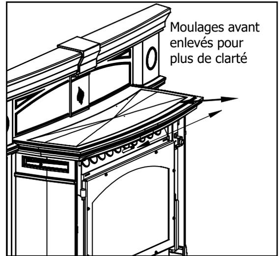
Figure 9 : Nettoyage de l'échangeur thermique du GCI60
