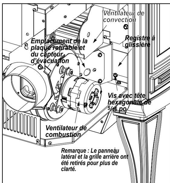
Figure 6 : Plaque du registre à glissière dans l'appareil
