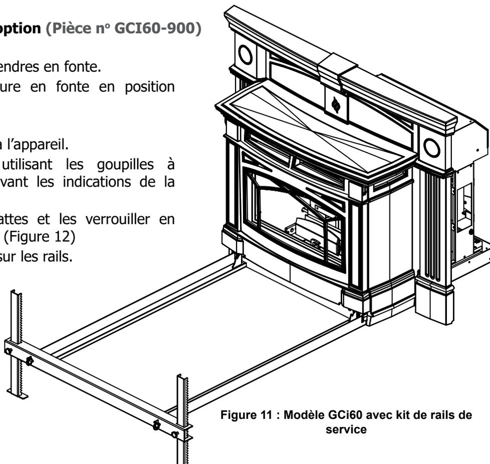
Figure 11 : Modèle GCI60 avec kit de rails de service
