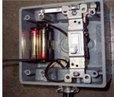
7. Installer les 4 piles AA dans chaque borne de piles. S'assurer de la bonne polarité des piles. Faire glisser d'abord la première borne de piles complètement vers la droite jusqu'à ce qu'elle se trouve près de l'interrupteur. La 2nde borne de piles peut être fixée à la plaque de couverture des piles à l'aide de la bande velcro fournie.
