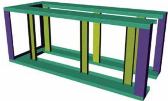
Schéma 6 - Installer les supports verticaux intérieurs
