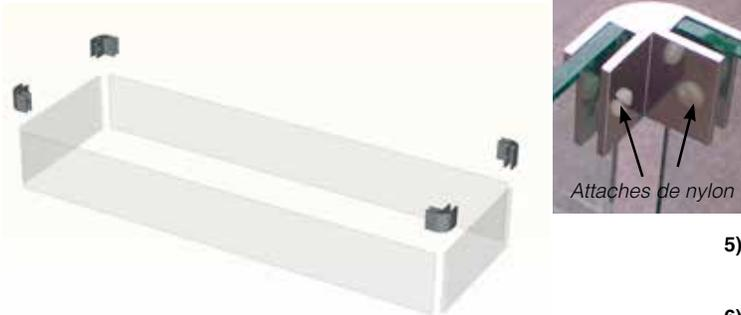
3. À l'aide d'un tournevis plat, serrer les 4 ferrures d'angle supérieures avec les attaches de nylon dans chaque angle. La ferrure doit être affleurante à la partie supérieure de la vitre, comme illustré ci-dessous.
