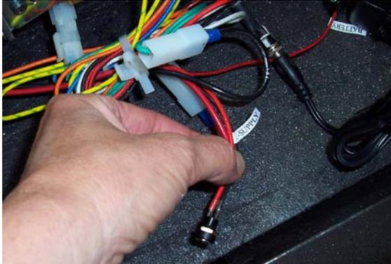
2) Connectez l'extrémité mâle de l'adaptateur CA à l'extrémité femelle étiquetée "Alimentation CC", sur le faisceau de câblage dans
