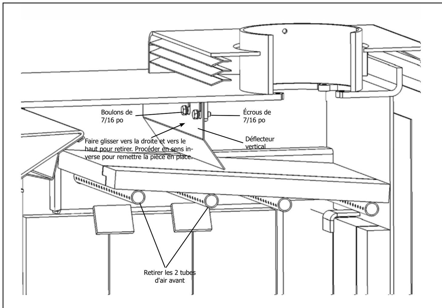
1. Retirer les 2 tubes d'air secondaire avant ou les déflecteurs en vermiculite (voir page 15).
