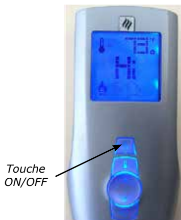
Schéma 2 Télécommande en mode Manuel sur Hi
