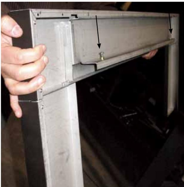
La partie inférieure de la façade installe sur l'appareil avec 2 glissière. Ces glissière sont situés dans le bas de l'appareil - déjà installé dans la glissière extérieure. Les glissière intérieure doivent être supprimés pour les installer sur les supports.
