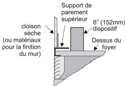
**Le support de parement supérieur, les bandes de clouage latérales et les deux dispositifs d'espacement doivent être positionnés et fixés correctement à l'appareil avant sa mise en place.**
