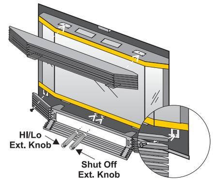
4) Ouvrir la grille inférieure. Sortir le commutateur du brûleur situé sous l'appareil et le placer sur la partie gauche de la grille, de façon à ce que les fentes de la ferrure coïncident avec les deux vis de la grille. Enfoncer la ferrure en place et la visser.
