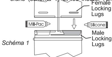
dans l'autre. Effectuer ensuite une rotation d'environ un quart de tour vers la droite jusqu'à ce que les deux conduits soient bien verrouillés. Les entailles ne sont pas visibles de l'extérieur des raccords ou des conduits. Regarder à l'intérieur pour les localiser.
