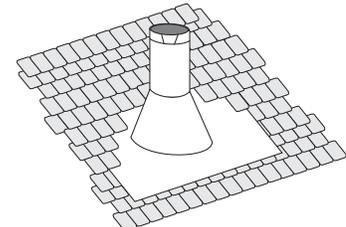
Schéma 4: Installer la moitié supérieure du solin sous les bardeaux. Attendre de poser la cheminée avant de la clouer en place afin de pouvoir l'ajuster légèrement au besoin.
