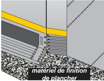
**REMARQUE: Le matériel de finition de plancher ne doit pas être plus haut que la base du foyer.**
