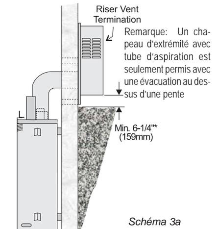
\*Schémas 3 & 4: Tel que spécifié dans le code d'Installation CGA B149. Les codes et règlements locaux peuvent exiger des dégagements différents.
