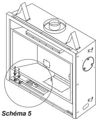
5) Dévisser partiellement les vis taraudeuses (vis Philips no 8) situées de chaque côté du châssis de l'appareil, dans la partie supérieure interne. Retirer la vis du centre.
