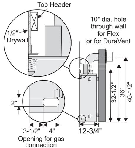
**Note: 40-1/2" (1029mm) est l' hauteur minimale pour conduits flexibles et rigides.**
