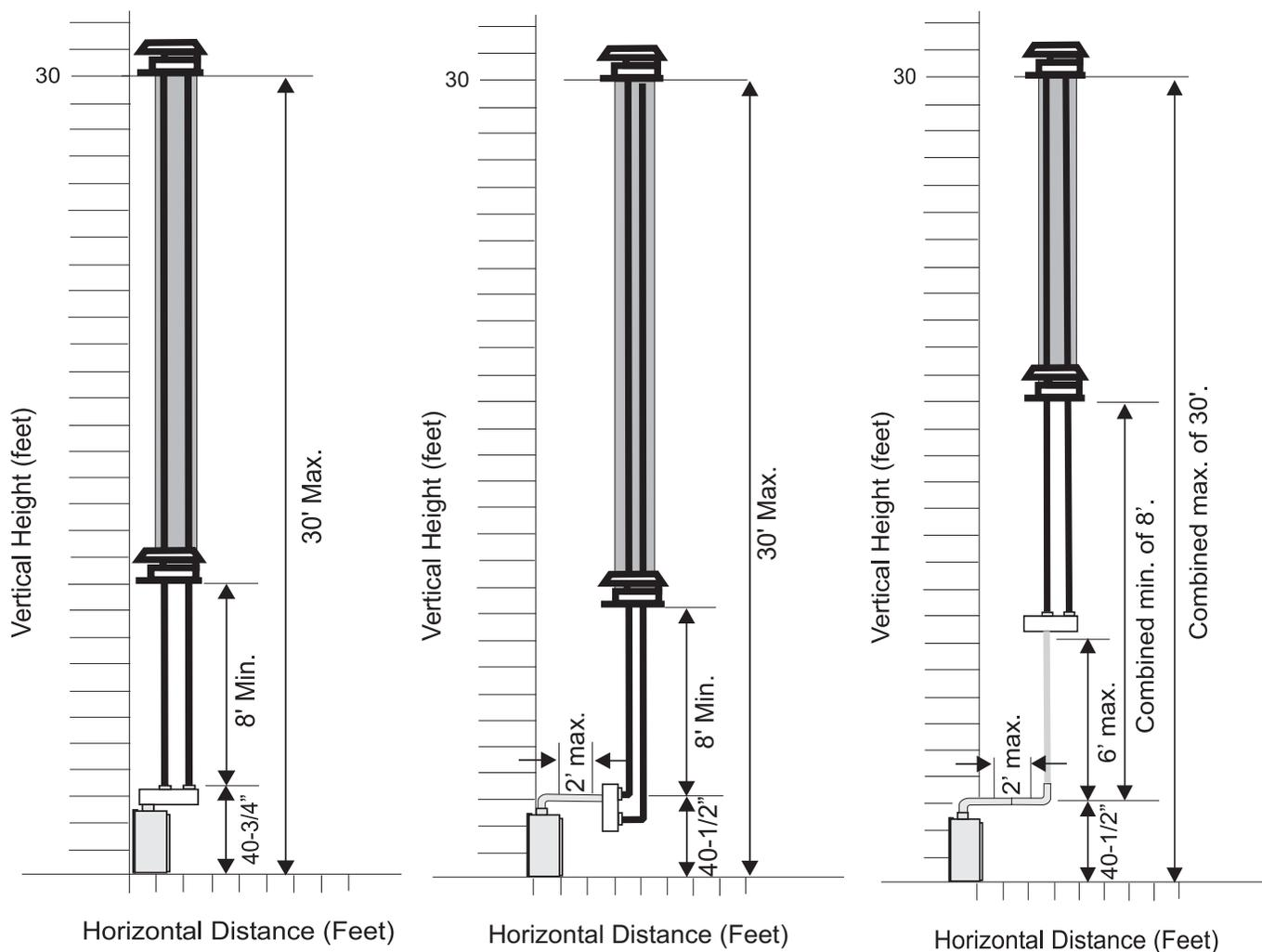
La zone ombragée du schéma indique les différentes combinaisons de sorties et de conduits verticaux.
