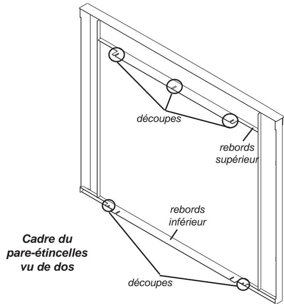
**REMARQUE:** Il est possible d'ajuster la profondeur du cadre d'environ  $\frac{1}{2}$  po pour que le mur et le foyer soient bien alignés.
