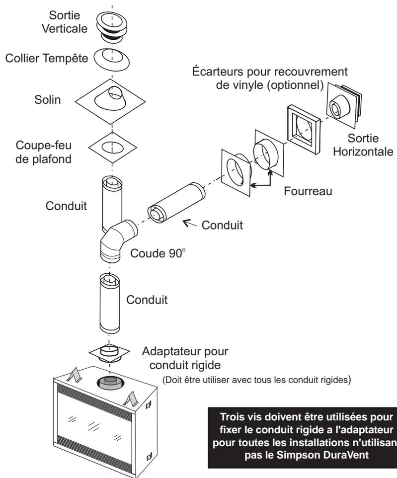
**Trois vis doivent être utilisées pour fixer le conduit rigide a l'adaptateur pour toutes les installations n'utilisant pas le Simpson DuraVent**
