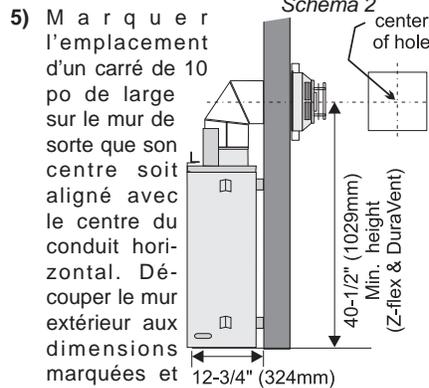
5) Marquer l'emplacement d'un carré de 10 po de large sur le mur de sorte que son centre soit aligné avec le centre du conduit horizontal. Découper le mur extérieur aux dimensions marquées et monter un cadre autour du trou, là où viendra se fixer la sortie. Si le mur percé est constitué de matériaux non combustibles, comme du béton ou de la pierre, un trou de 7 po (178 mm) de diamètre, ou de 7 1/2 po (191 mm) dans le cas de conduits flexibles, peut convenir.
