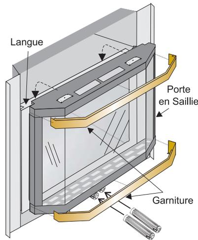
2) Installer la grille d'aération inférieure en saillie en insérant les deux équerres (fixations) dans les ferrures situées sous la porte en saillie. Fixer la grille en vissant une vis dans chacune des plaques de fixation, comme le montre le schéma ci-dessous.
