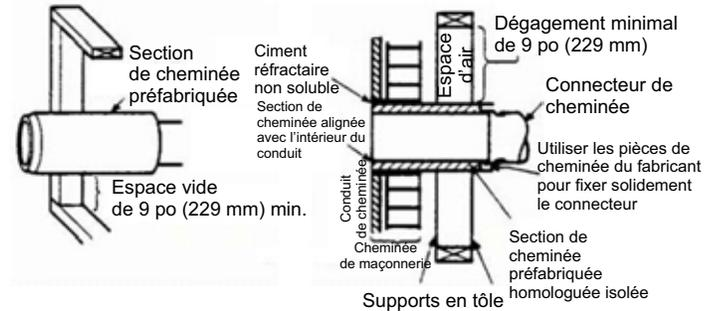
Dégagement minimal de 2 po (51 mm) de la cheminée aux supports en tôle et matériaux combustibles
