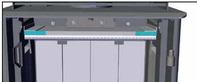
*Fixations et plaques de recouvrement des déflecteurs dans leur emplacement définitif*
