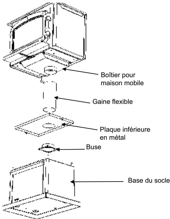
10. Fixer la buse à la base de l'appareil à l'aide de 4 vis.
