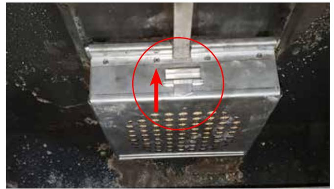
8. Tirer vers soi le protecteur de flamme et le faire basculer vers le bas tout en retenant le dispositif du catalyseur.
