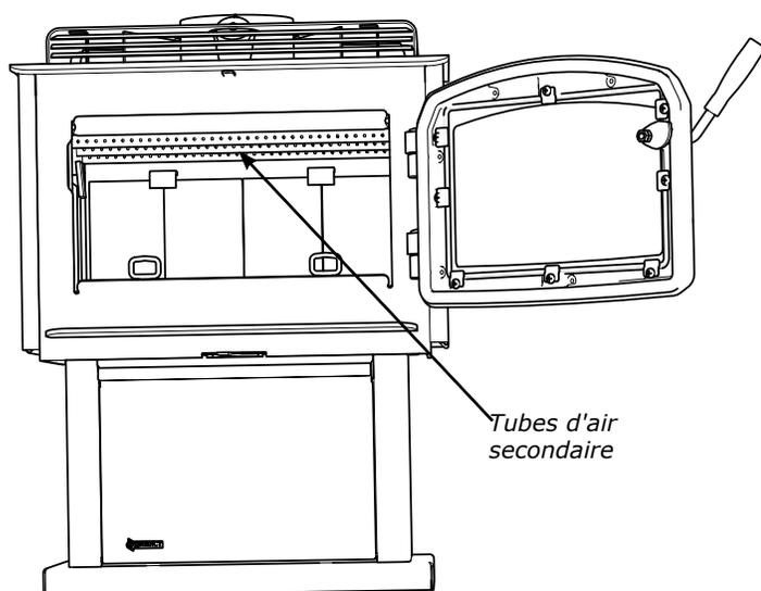
3. À l'aide d'une pince-étau, saisir fermement le tube d'air secondaire avant en premier. Frapper sur la pince avec un marteau, de droite à gauche, afin de dégager le tube de son emplacement. Le retirer. Voir schéma 1.
