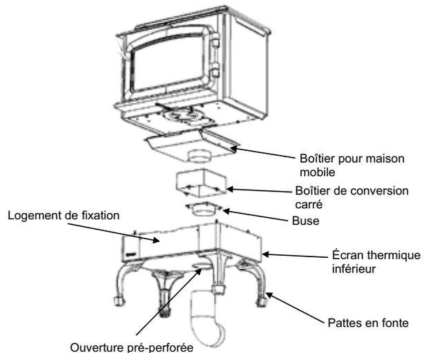
17. Retirer l'ouverture pré-perforée située sur l'écran thermique inférieur et plier les languettes restantes une fois l'ouverture pré-perforée mise sur le côté.
