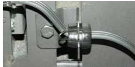
Fixer le dispositif anti-traction pré-réglé
