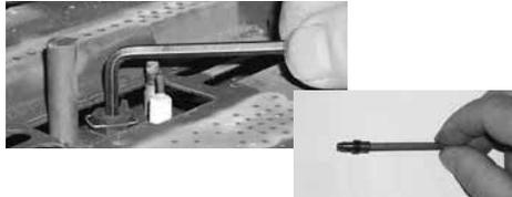
7) Dévisser l'orifice du brûleur à l'aide d'une clé de 1/2 po et le mettre de côté. Se servir d'une autre clé pour stabiliser le coude à l'arrière de l'orifice.
