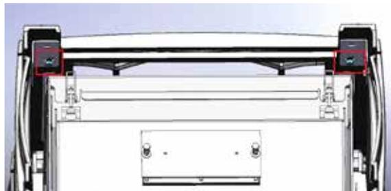
6) Ouvrir la porte d'accès de la valve et dévisser les boulons de la façade moulée inférieure à l'aide du même outil.
