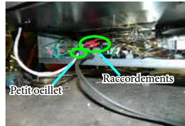
8. Brancher les raccordements (noir et rouge) du fil gris du ventilateur aux raccordements IFC (noir et rouge).
