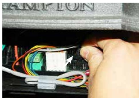
11) Retirer le moteur pas-à-pas au gaz naturel en retirant deux vis aux endroits montrés ci-dessous. Remplacer par un moteur pas-à-pas au propane liquide, puis le fixer à l'aide de deux vis.
