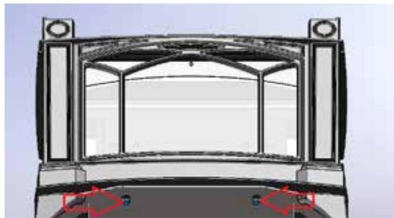
7) Faire glisser la moulure hors de la plaque de la base et des rainures du support en forme de serrure, puis soulever la façade moulée pour la dégager de l'appareil.
