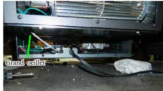
7. Faire passer le fil gris du ventilateur dans le petit œillet du câble d'alimentation, de la plaque de couverture de la valve jusqu'au panneau de la base, en passant par le grand œillet.
