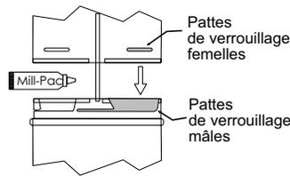
**Remarque : Pour de meilleurs résultats et une performance optimale d'un système d'évacuation homologué, il est vivement recommandé d'appliquer du scellant Mill-Pac (fourni) sur chaque raccord de conduit intérieur. Le non-respect de cette procédure peut causer des problèmes de tirage ou de performance qui ne sont pas couverts par la garantie.**
