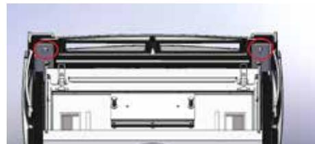
4. Faire glisser la fixation du dispositif de l'éclairage pour le mettre de côté.
