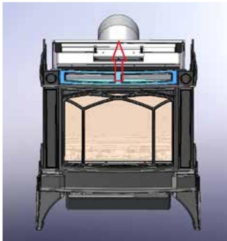
4) Retirer le dispositif de l'éclairage et le mettre soigneusement de côté.
