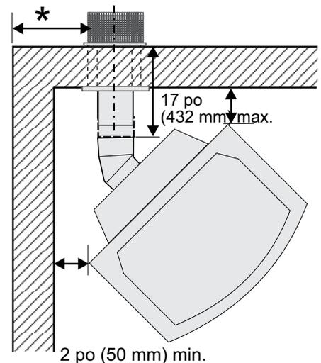
\*Si l'appareil est installé dans un coin extérieur, la distance minimale entre l'évacuation et le coin extérieur est de 6 po (15 cm). Voir «F» sur le schéma de la section «Emplacements des sorties d'évacuation extérieures».
