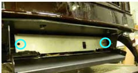
Retirer la plaque de recouvrement de la valve
