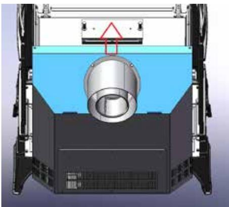
2) Dévisser les boulons de fixation de la grille du couvercle moulé à l'aide d'une clé à douille de 7/16 po ou 11 mm.
