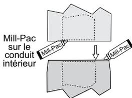
**Remarque : Le joint du conduit doit être orienté vers le bas.**
