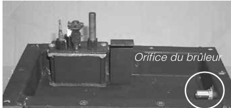
8) Réinstaller le nouvel orifice du brûleur au propane liquide portant le numéro 52 et le fixer solidement.
