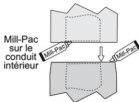
**Remarque : Pour de meilleurs résultats et une performance optimale d'un système d'évacuation homologué, il est vivement recommandé d'appliquer du scellant Mill-Pac (fourni) sur chaque raccord de conduit intérieur. Le non-respect de cette procédure peut causer des problèmes de tirage ou de performance qui ne sont pas couverts par la garantie.**
