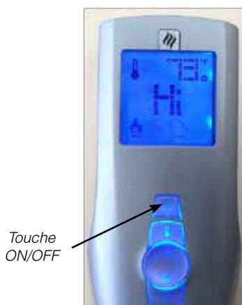
Schéma 2 - Télécommande en mode manuel sur "Hi"
