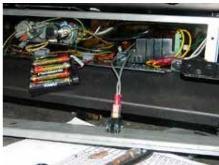
4. Installer 4 piles AA dans le boîtier et remettre ce dernier dans son emplacement.
