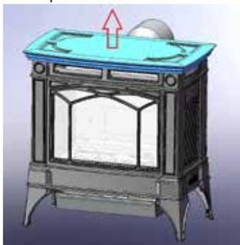
4. Dévisser les boulons qui maintiennent la façade moulée. Faire glisser la fixation du dispositif de l'éclairage pour le dégager.
