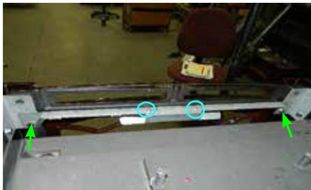
*Soulever la fixation du dispositif de l'éclairage pour la dégager des boulons et installer l'ampoule.*
