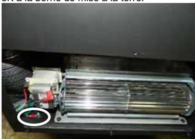
5. Ouvrir la plaque de couverture à la base de l'appareil en desserrant les 2 vis et en retirant celle qui se trouve sur le côté gauche de l'appareil (en faisant face à l'arrière de l'appareil).
