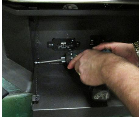
3. Retirer les quatre vis pour enlever le panneau d'accès (aux emplacements indiqués ci-dessous) et la chaîne fixée à la porte avant et à l'appareil.
