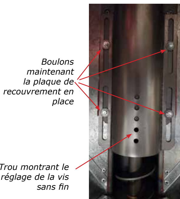
Plaque de recouvrement de la vis sans fin de la trémie. Réglée pour s'adapter aux granules plus larges.
