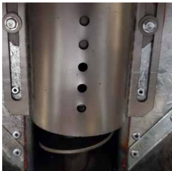
Plaque de recouvrement de la vis sans fin de la trémie. Réglage d'usine : deux trous fermés et trois ouverts
