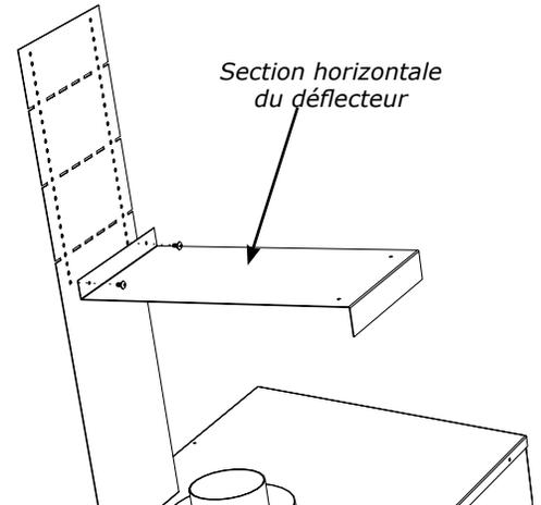
4. Si la rallonge du déflecteur est nécessaire, placer les 2 vis, puis régler à la longueur désirée avant de serrer les vis.
