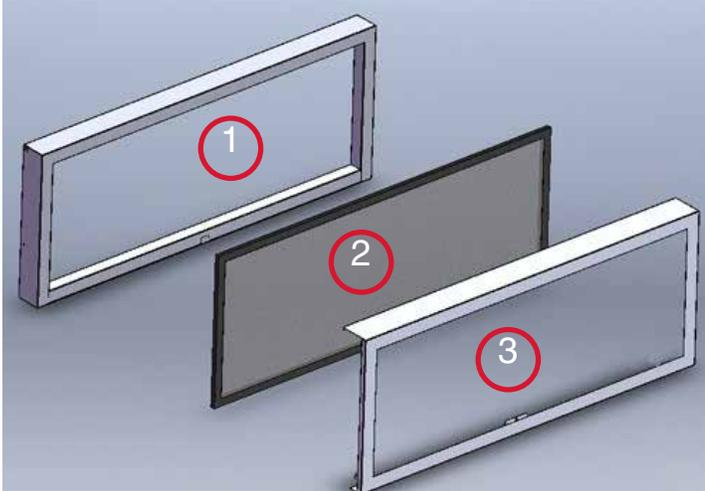
2. Installer le pare-feu sur le cadre de porte intérieur - fixer le pare-feu en pliant les 6 languettes dans les emplacements indiqués ci-dessous.
