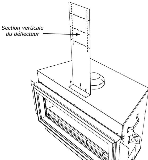
3. Fixer la section horizontale du déflecteur à la section verticale à la hauteur désirée à l'aide de 2 vis.
