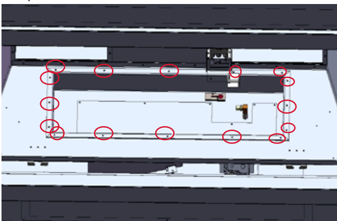
Schéma 4 - Emplacements des vis du plateau de la valve
