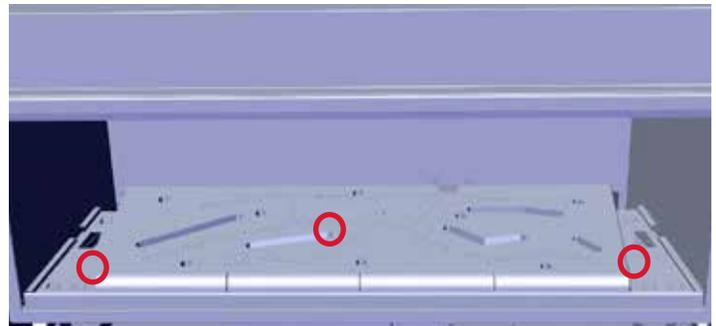
Schéma 3 - Emplacement des vis du brûleur
