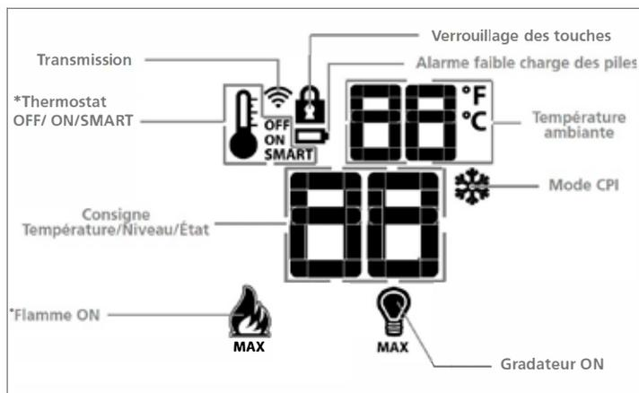
Schéma 2 : Afficheur LCD de la télécommande
