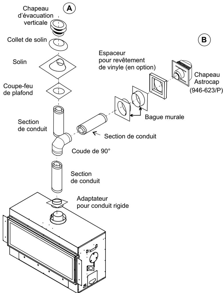
**Pour tout système d'évacuation rigide (sauf Simpson Dura-Vent), le conduit rigide doit être fixé à l'adaptateur à l'aide de 3 vis.**
