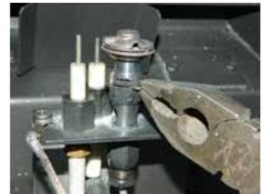
8. Sortir le capuchon de la veilleuse pour dégager l'orifice de la veilleuse (voir ci-dessous).
