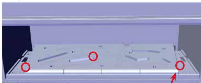
Schéma 2 - Emplacement des vis du brûleur
