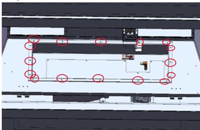
Schéma 4 - Emplacements des vis du plateau de la valve
