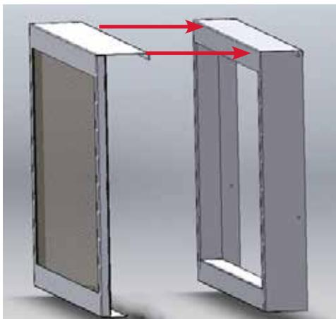
4. Plier vers le haut la languette centrale et la fixer avec une vis pour attacher l'ensemble formé par le cadre de porte intérieur et le pare-feu à la bordure intérieure de la porte.
