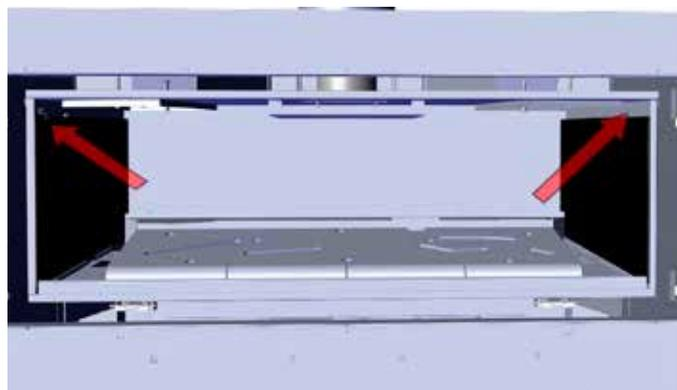
Emplacement des vis des attaches des panneaux
