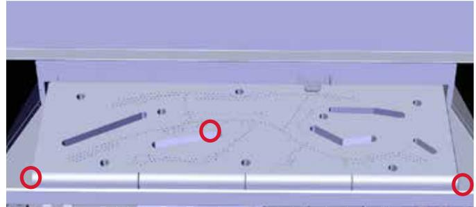
Schéma 3 - Emplacement des vis du brûleur
