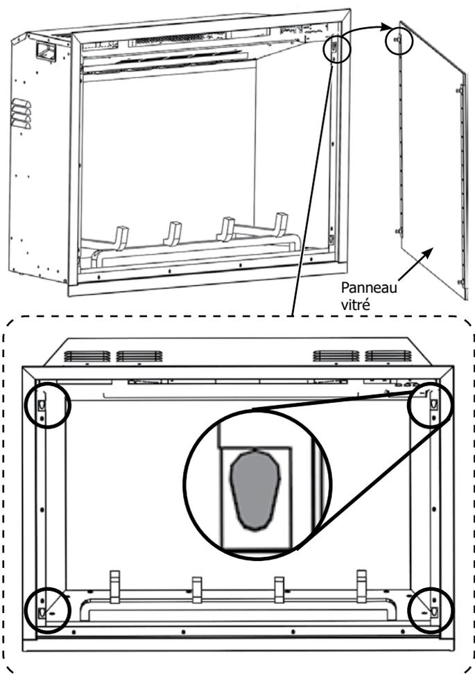
3. Pour réinstaller la vitre, inverser les étapes 1 et 2. Le panneau vitré s'insère simplement dans les 4 fentes comme indiqué sur le schéma ci-dessus. Veiller à ce que la ventouse soit rangée en toute sécurité pour une utilisation ultérieure.
