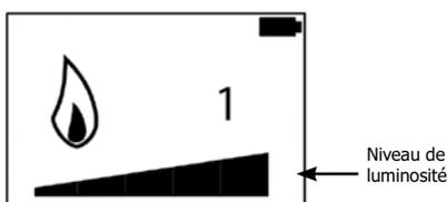
Appuyer sur le bouton '+' pour augmenter la luminosité des flammes.
