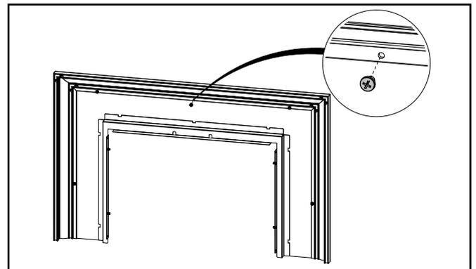
7. Soulever la façade et le contour traditionnel et se reporter à la section "Installation de la façade/ de la bordure de finition".
