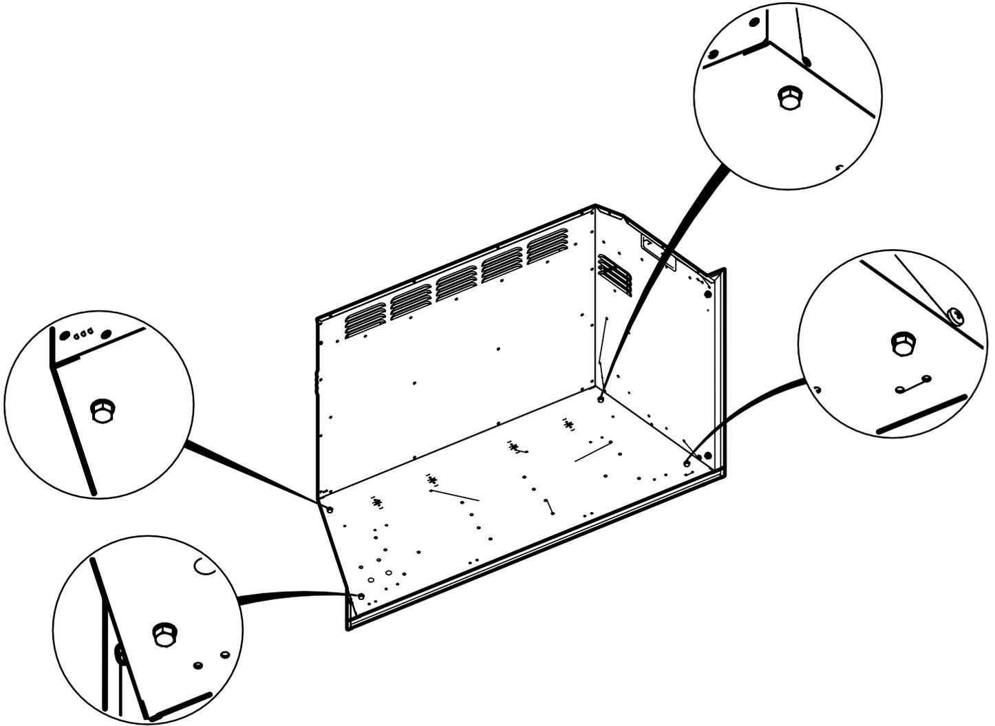
Les boulons de nivellement fournis doivent être installés avec les boulons par le bas, comme illustré ci-dessus. Poser l'appareil sur le dos et fixer les 4 boulons comme indiqué ci-dessus. Une fois l'appareil en place, régler les boulons pour s'assurer qu'il est de niveau et qu'il ne bascule pas.
