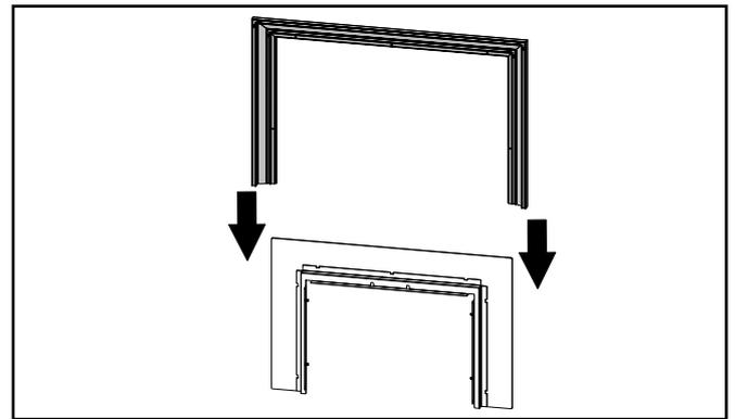
6. Insérer et serrer les vis à l'arrière (x5). Contour traditionnel installé.
