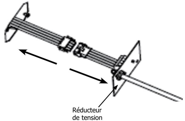
Installer une douille de collier de serrage dans la plaque de recouvrement.
