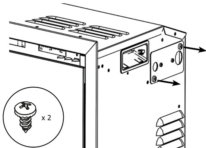
**IMPORTANT :** L'interrupteur à bascule, qui sera maintenant exposé une fois la plaque de câblage retirée, devra être positionné à 120 VCA ou 240 VCA en fonction de la tension d'alimentation de l'appareil.
