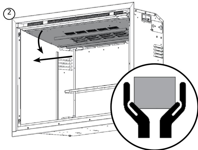
À noter que les trappes du déflecteur arrière sont placées au-dessus des trappes du support arrière, comme illustré ci-dessous.
