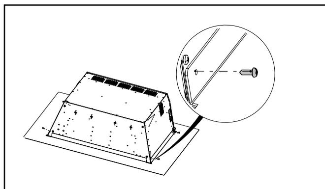
6. Retourner l'appareil à la verticale : la façade à 4 côtés est installée.
