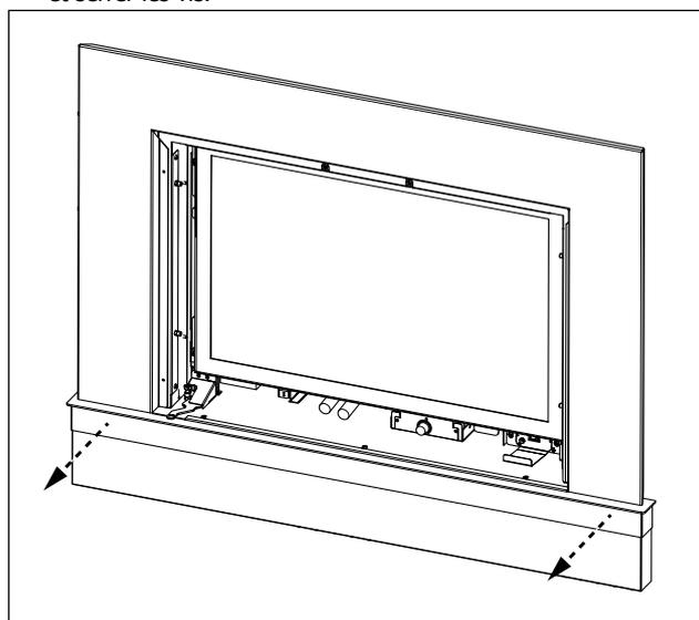
1b. Pour les installations du modèle Ei29, fixer sans serrer la garniture d'âtre à l'aide des vis fournies depuis la partie inférieure vers la partie supérieure.
