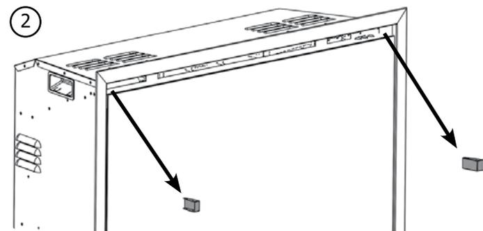
Utiliser avec précaution la ventouse fournie pour retirer la vitre en soulevant les tiges pour les dégager des fentes situées à l'avant de l'appareil.
