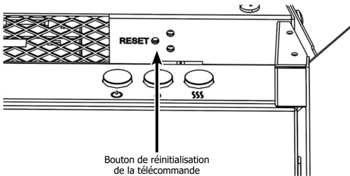
**La réinitialisation de la télécommande est nécessaire si l'appareil fonctionne mal en raison d'un signal d'interférence externe et que la télécommande n'est pas utilisée.**
