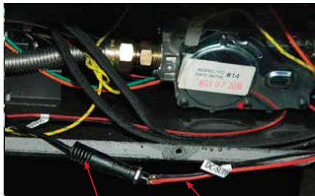
Adaptateur AC Câble d'alimentation en courant continu (DC) du faisceau de câblage
