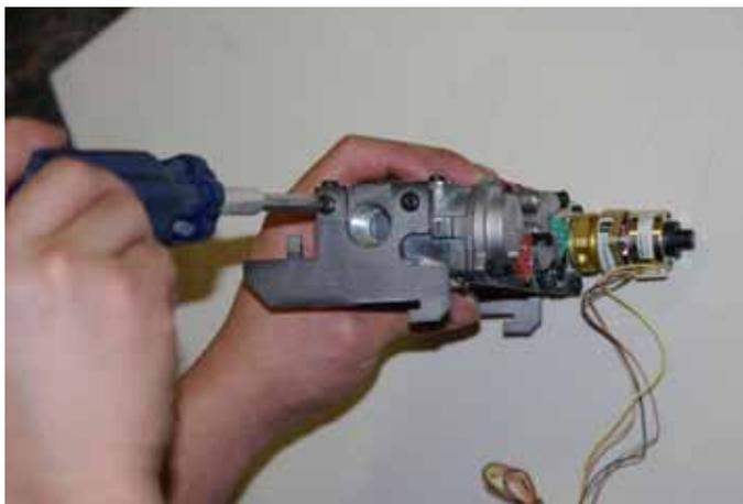
11) Un point de prise y est prévu pour fixer d'autres composantes et peut servir à maintenir la soupape dans un étau.
