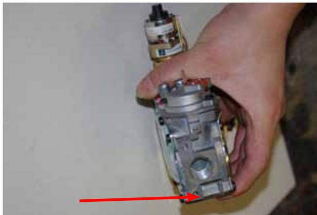
12) Fixer la soupape dans un étau en la serrant au niveau de ce point de prise. Éviter de trop serrer. Dévisser le raccord conique à la sortie de la soupape.
