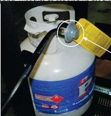
*Raccord du gaz au réservoir*
