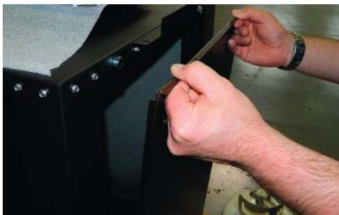
2) Enlever le panneau latéral (panneau de gauche si vous faites face au panneau où se trouve l'interrupteur) pour accéder au raccord de 3/8 po de la commande de gaz.
