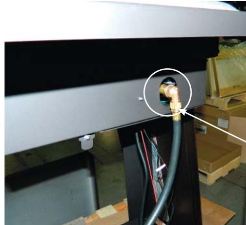
*Raccord du gaz au réservoir*
