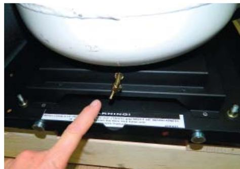
5) Raccorder le régulateur de PL à branchement rapide au réservoir
