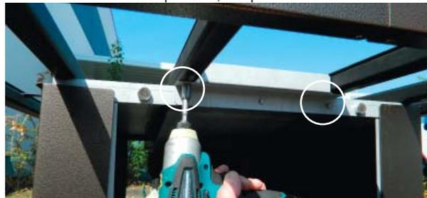
3) Placer les 10 tranches sur le haut de la table (voir Schéma) avant d'installer les carreaux
