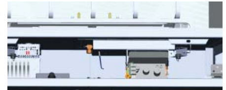
Câble de réglage: situé à la gauche du plateau. Pousser pour fermer ou tirer pour ouvrir
