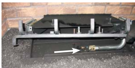
Schéma 2: Glisser le brûleur vers le droite et le soulever
