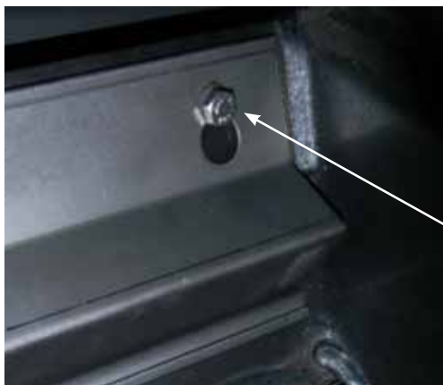
S'assurer que le déflecteur est bien en place de manière à ce que les boulons soient placés sur le haut du trou en forme de serrure avant de les serrer.
