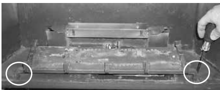
Retirer les 2 vis, pousser le dispositif du brûleur vers la gauche et le soulever.
