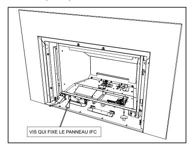
**REMARQUE :** Lors de la réinstallation, les câbles doivent être fixés par des bandes Velcro.
