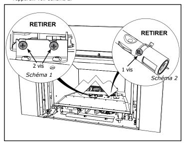
À l'aide d'un tournevis à tête Phillips, retirer les vis qui fixent le déflecteur arrière.
