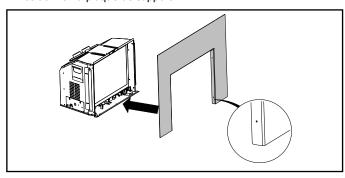
3. Fixer quatre vis sur les deux côtés pour attacher la plaque de support en s'assurant qu'elles reposent à l'avant des fentes.
