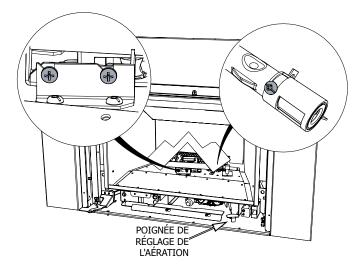
5. Installer la bûche #2, la bûche du brûleur, au-dessus de la protection de la veilleuse.
