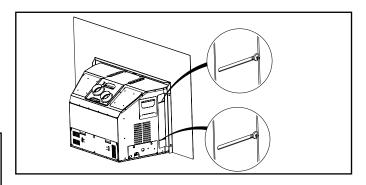
8. Tirer la plaque de support aussi loin que possible vers l'avant contre la façade, puis resserrer les vis sur les deux côtés.
