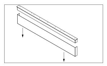
2. Si une meuleuse est utilisée (recommandé) : Couper la section inférieure à hauteur, en se référant au tableau d'installation pour déterminer la quantité à enlever.
