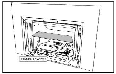
6. La gaine flexible du gaz peut également être débranchée.
