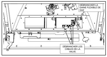
Retirer les 2 vis Phillips qui fixent le couvre-fils et le placer dans un endroit sécuritaire.
