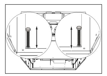
4. On peut accéder aux boulons de nivellement avant depuis l'avant de l'encastrable, sur les côtés inférieurs gauche et droit. Une fois l'appareil en place, régler les boulons pour s'assurer que l'appareil est de niveau et n'est pas instable.
