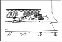
Retirer le couvercle de gestion des câbles (fixé par 2 vis). Retirer les sangles de gestion des câbles pour accéder aux câbles.
