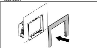
6. Fixer les quatre vis sur les deux côtés pour attacher la façade.
