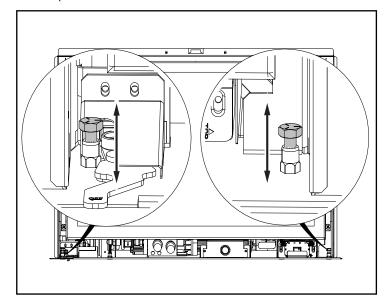
5. Depuis le dessous : Les boulons peuvent être retournés et installés depuis la partie inférieure de l'encastrable pour une augmentation de la longueur. Une fois en place, régler les boulons pour s'assurer que l'appareil est de niveau et ne bougera pas.
