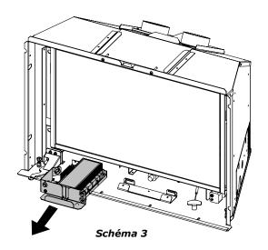
3. Débrancher le faisceau d'alimentation principal (X1) au niveau du panneau de commande PF11 IFC et déconnecter le fil de terre de la borne de masse.
