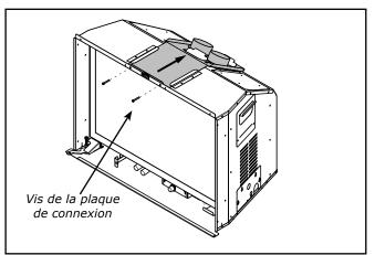
2. Retirer la buse de 3 po sur la plaque de connexion en dévissant les 4 vis.
