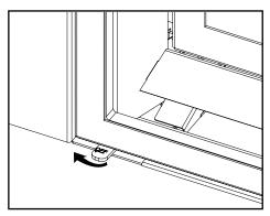
L'interrupteur doit être en position ON (tourné vers la droite) pour que la télécommande allume l'appareil. En déplaçant l'interrupteur vers la gauche, le brûleur s'éteint.
