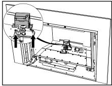
Tirer le capuchon de la veilleuse pour dégager l'orifice de la veilleuse.
