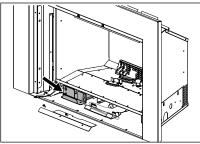
Débrancher le câble venant du moteur du régulateur de pression sur la carte IFC (identifié X6 sur le panneau IFC).
