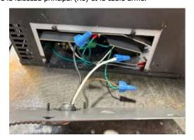
13. Rentrer les fils dans l'appareil à l'aide des attaches de fils et de la pince porteconducteur et remettre le couvercle latéral en place.
