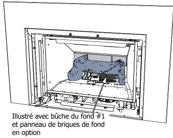
4. Réinstaller et fixer à la fois le brûleur et le capuchon d'aération retirés à l'étape 2a et 2b. Ne pas trop serrer la vis du capuchon d'aération lors de la réinstallation. Bouger la poignée de l'aération pour vérifier qu'elle fonctionne toujours correctement.
