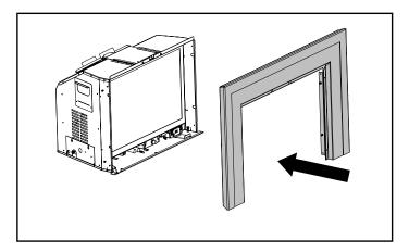
3. Fixer les quatre vis des deux côtés pour attacher la façade / la bordure de finition.
