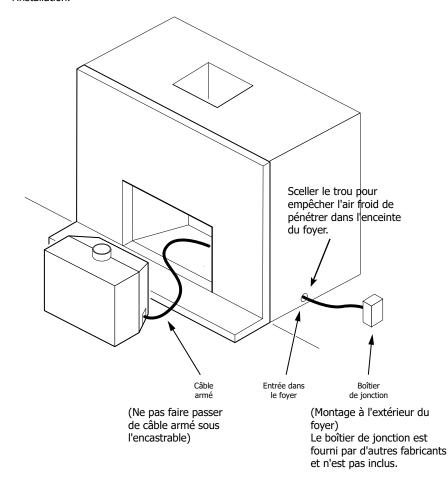
REMARQUE : Modèle illustré avec câble armé situé sur la droite. Selon le modèle ce câble peut se trouver sur la gauche.
