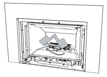
3. Installer la bûche du fond #1 et le panneau de briques du fond comme illustré ci-dessous. Le panneau de briques du fond n'est pas requis et est en option. Installer seulement le panneau de briques du fond en cas d'installation du jeu de panneaux de briques en option.
