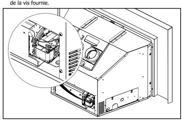
4. Retirer le ventilateur de l'appareil en le soulevant de ses axes.
