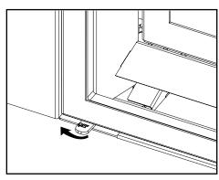
L'interrupteur doit être sur la position ON poussé vers la droite) pour que que la télécommande puisse allumer l'appareil. En déplaçant l'interrupteur vers la gauche, le brûleur s'éteint.
