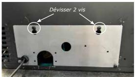
Retirer la vis qui fixe le panneau IFC et tirer le panneau IFC pour le dégager et accéder au faisceau électrique principal.
