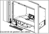
Retirer la vis de fixation du plateau IFC, puis le faire glisser pour accéder au câble du moteur.
