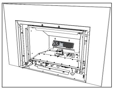
4. À l'aide d'un tournevis à tête Phillips, retirer les vis qui fixent la protection de la veilleuse.
