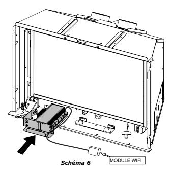
Fixer la clé électronique sur la partie inférieure droite de l'encastrable, à côté des piles. Les fils peuvent être placés avec les autres sous le couvre-fils.
