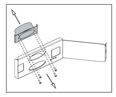
1. Retirer la plaque située sur le dessus de l'appareil en dévissant la vis à 3. Fixer la buse de 2 po sur la plaque en utilisant les 4 vis qui étaient en place avec la buse de 3 po.
