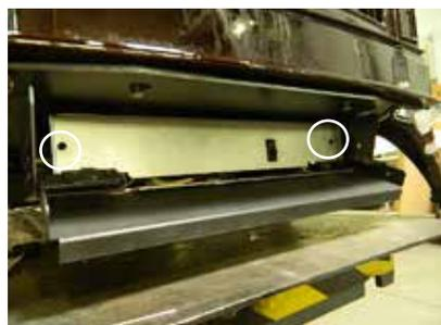
10. Enlever le panneau d'accès gauche (en faisant face à l'appareil) en retirant une vis, puis débrancher les câbles du moteur pas-à-pas au gaz naturel du récepteur à l'endroit indiqué ci-dessous.
