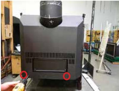
4. Enlever le panneau d'accès latéral gauche (en faisant face à l'appareil) en retirant les deux vis.
