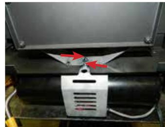
8. Une fois le dispositif de ventilation inséré dans les encoches, serrer les boulons à l'aide d'une clé.
