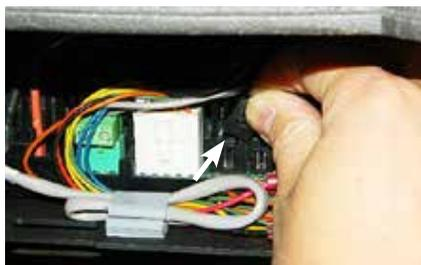
11. Enlever le moteur pas-à-pas au gaz naturel en retirant les 2 vis aux endroits montrés ci-dessous. Le remplacer par le moteur pas-à-pas au propane liquide, puis le fixer à l'aide des deux vis.
