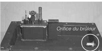
8. Réinstaller le nouvel orifice du brûleur au propane liquide portant le numéro 54 et le fixer solidement.
