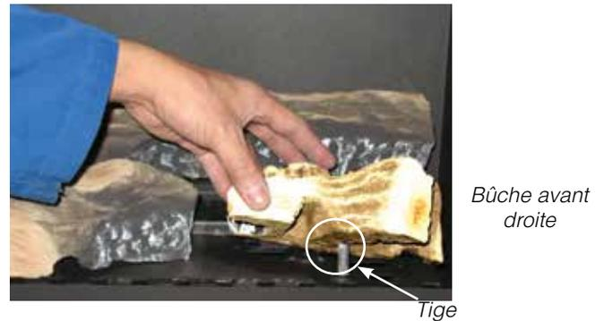
Les rebords avant de la bûche avant droite doivent être placés en parallèle contre le rebord avant du brûleur.
