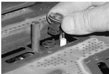
6. Dévisser l'orifice de la veilleuse à l'aide de la clé hexagonale Allen et le remplacer par l'orifice de la veilleuse au propane liquide compris dans la trousse, puis remplacer la coiffe de la veilleuse.
