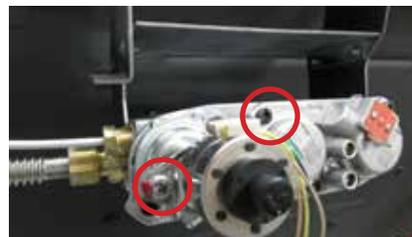
12. Brancher le moteur pas-à-pas au propane liquide au récepteur (dans le même port que le moteur au gaz naturel retiré à l'étape 10), puis réinstaller le panneau d'accès.
