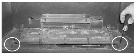
Retirer les 2 vis, pousser le dispositif du brûleur vers la gauche puis le soulever pour le sortir.
