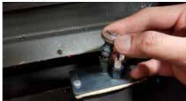
10. Dévisser l'orifice de la veilleuse avec la clé Allen et le remplacer par l'orifice de la veilleuse au propane qui se trouve dans la trousse de conversion.
