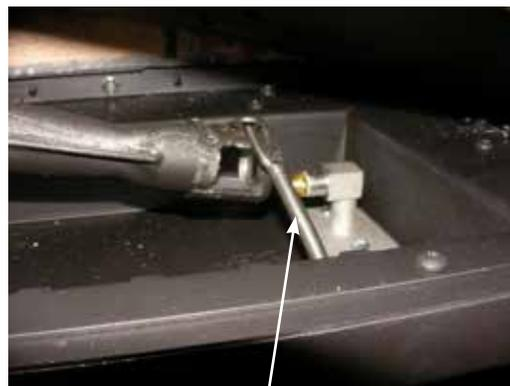
Câble de réglage de l'arrivée d'air
