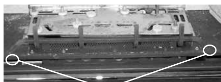
Oter les 2 vis qui maintiennent la grille en place
