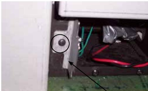
Schéma 8 Ferrure de fixation
