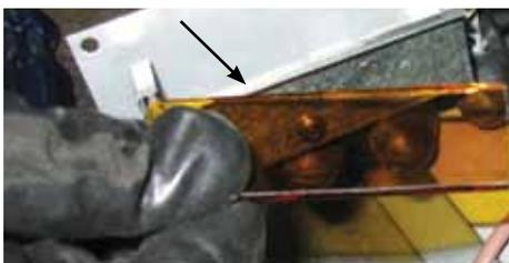
14) Placer le joint sur le périmètre intérieur de la boîte de diffuseur de lumière.
