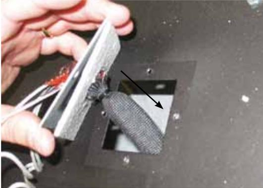
11) Retirer les deux plaques de recouvrement et les joints situés dans la partie avant inférieure de la chambre de combustion en enlevant les quatre vis de chaque plaque - voir ci-dessous. Jeter les couvercles et les joints - conservez les vis.
