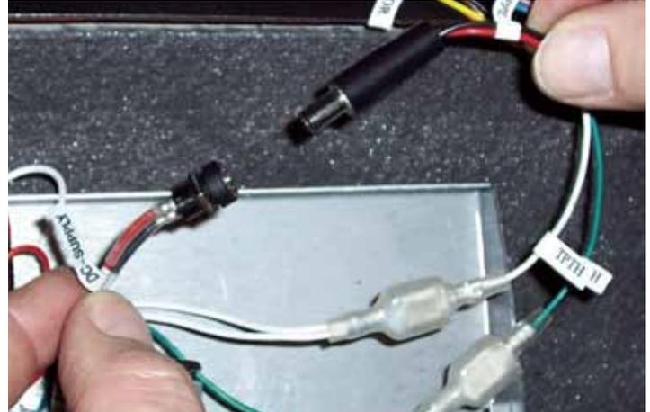
**Remarque :** NE PAS INSÉRER de piles dans le bloc-piles. Le CNB est maintenant alimenté par les piles du récepteur mural.
