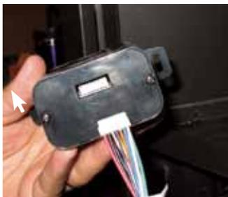
12) Brancher le fil du moteur pas-à-pas marqué « GTM motor » au connecteur restant du récepteur.
