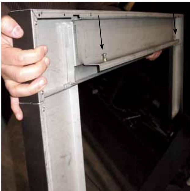
La partie inférieure de la façade installée sur l'appareil avec 2 glissières. Ces glissières sont situées dans le bas de l'appareil - déjà installées dans la glissière extérieure. Les glissières intérieures doivent être supprimées pour les installer sur les supports.
