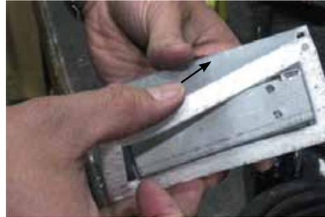
15) De l'extérieur de la boîte de foyer - Installer le montage de la lumière et le joint dans l'ouverture créée par l'enlèvement des plaques de recouvrement ouverture vers le haut - comme indiqué ci-dessous.
