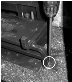
Schéma 1: Retirer les vis de gauche et de droite.
