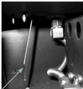
Tige de l'arrivée d'air - située à gauche de la valve
