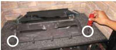
Schéma 1 : Dévisser les deux vis du brûleur.
