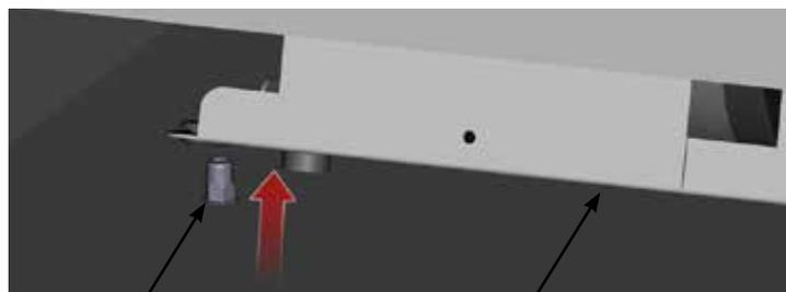
Tiges sur le plancher de l'appareil
