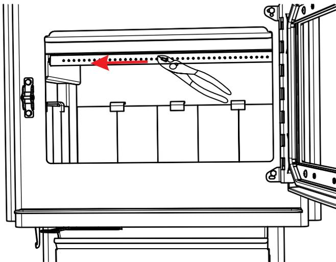
5. Pour réinstaller ou remplacer les tubes, faire glisser d'abord le côté gauche du tube dans le trou de la conduite d'air de gauche. Aligner ensuite l'encoche de son extrémité droite avec la languette de la conduite d'air de droite. Saisir fermement le centre du tube à l'aide d'une pince-étau puis frapper sur la pince avec un marteau, de gauche à droite, jusqu'à ce que le tube soit bien inséré dans la conduite d'air sur la droite.
