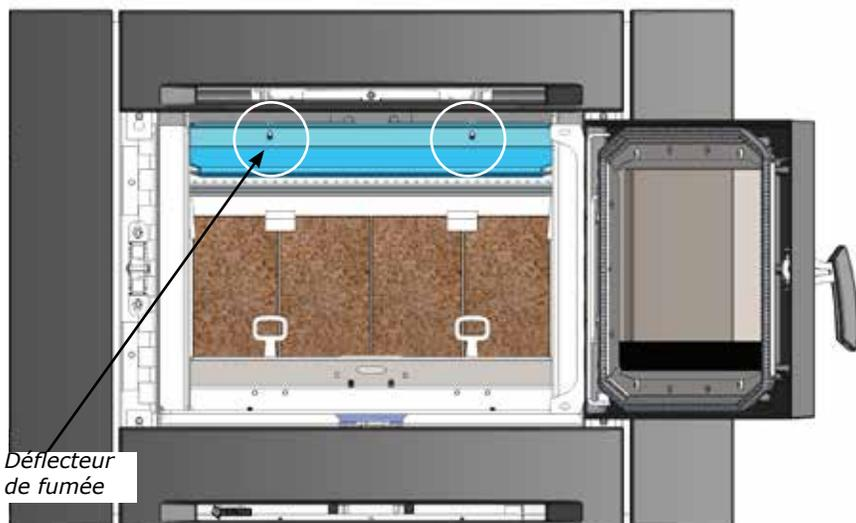
Le déflecteur de fumée est installé par l'ouverture de la porte dans l'emplacement indiqué sur le schéma ci-dessus.
