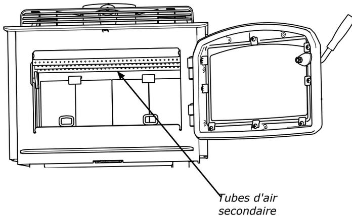
3. À l'aide d'une pince-étau, saisir fermement le tube d'air secondaire avant en premier. Frapper sur la pince avec un marteau, de droite à gauche, afin de dégager le tube de son emplacement.
