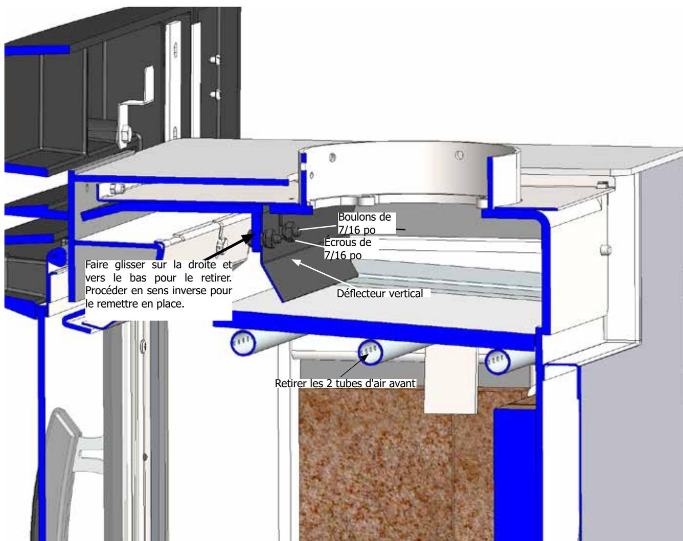
1. Retirer les 2 tubes d'air secondaire avant et les déflecteurs en vermiculite (voir le manuel pour plus de détails).
