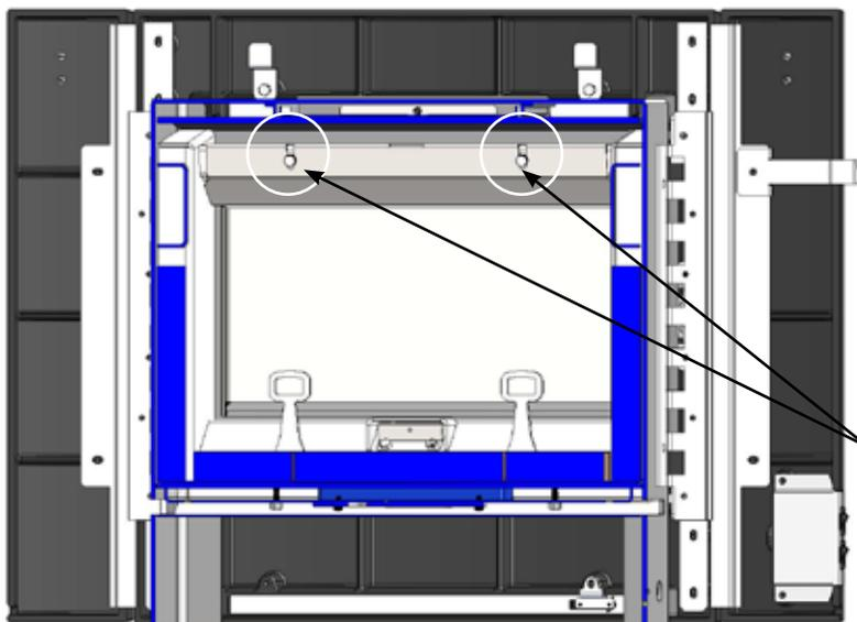
S'assurer que le déflecteur est bien en place de manière à ce que les boulons soient placés au fond de la fente en forme de serrure avant de les serrer.
