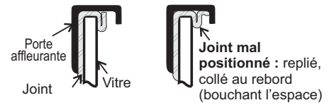
Position correcte de la porte, de la vitre et du joint.
