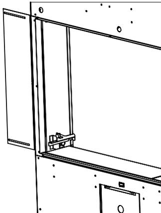
9. Faire glisser les panneaux latéraux extérieurs #6 entre le mur et le support du butoir de la vitre. Refaire les étapes pour installer les trois panneaux extérieurs #6 restants à l'aide d'un butoir au besoin.
