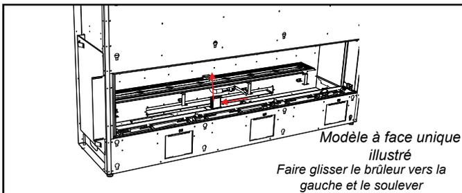
13. Enlever l'orifice du brûleur à l'aide d'une clé de 3/8 po. Utiliser une autre clé pour tenir le coude derrière l'orifice. Mettre de côté l'orifice. Réinstaller le nouvel orifice du brûleur pour propane n°50 et le serrer.
