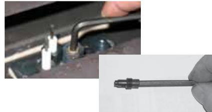
16. Réinstaller le capuchon de la veilleuse et la pince de retenue de la veilleuse.
