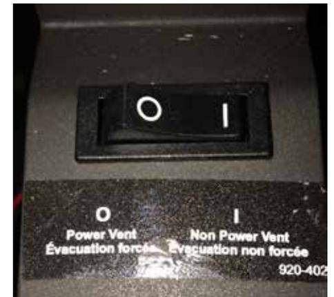
**REMARQUE** Ce commutateur doit être mis en place au moment de l'installation et ne doit jamais devoir être déplacé d'un emplacement à l'autre. Ce commutateur est caché pour éviter que le propriétaire ne le place dans la mauvaise position.
