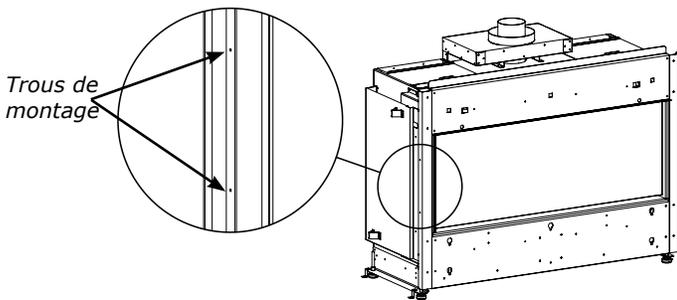
3. Fixer les panneaux de la base de gauche et de droite à l'aide de 2 vis de chaque côté. Retirer le contour de finition de la cloison sèche des deux côtés de l'ouverture vitrée à l'aide du tournevis à angle droit fourni. Il suffit de desserrer les vis pour retirer les deux bordures de finition. Une fois enlevées, resserrer les vis et jeter la bordure de finition.
