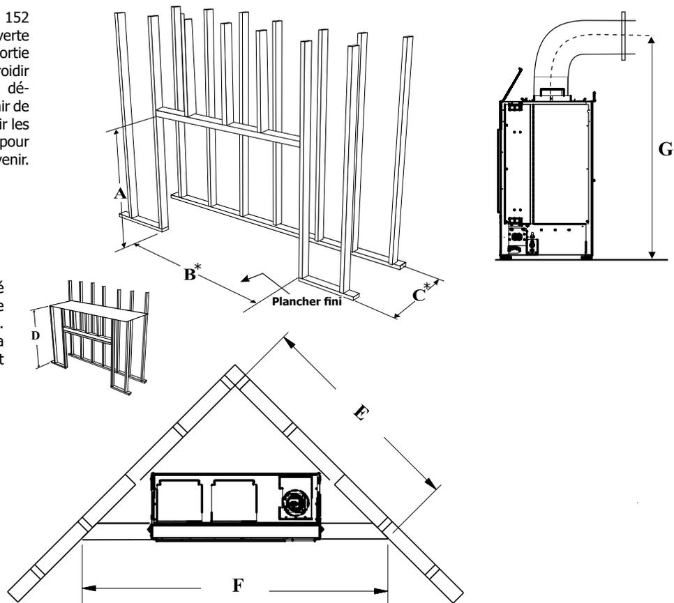
\* La profondeur/largeur de l'encadrement ne tient pas compte des cloisons sèches, du bois ou de matériaux similaires contre les murs arrière/côtés. La profondeur de l'encadrement devra être modifiée en fonction de l'épaisseur du matériau.
