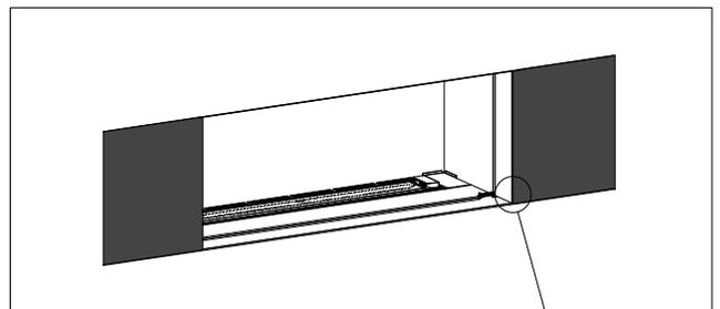
Installation correcte des panneaux vitrés
