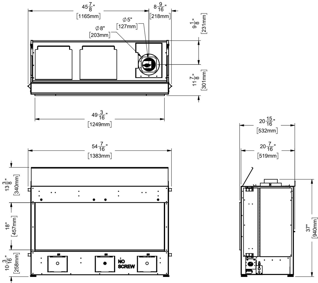
Remarque : La hauteur de l'appareil peut varier en fonction de celle des pattes de nivellement.
