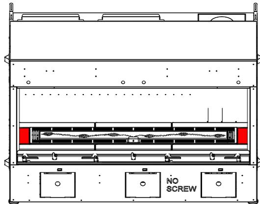
4. Installer les 5 vis de manière lâche et installer les trois panneaux #3 à l'arrière de la chambre de combustion.
