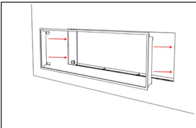
4. Plier à la main les languettes de fixation pour qu'elles dépassent les aimants et atteignent la fixation de support.
