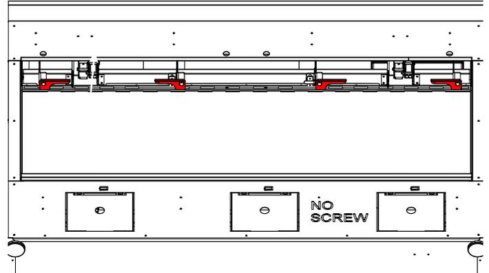
Une fois les attaches supérieures en position ouverte, utiliser les mains pour tirer vers soi les deux rails de support de la vitre.
