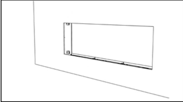
2. Avant d'installer les panneaux de la doublure extérieure et l'écran vitré, retirer les plaques de la bordure de finition des deux côtés du foyer.
