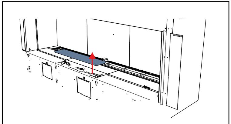
2. Depuis l'intérieur de l'appareil, pousser la languette vers l'intérieur pour dégager le panneau d'accès sur le dessus.
