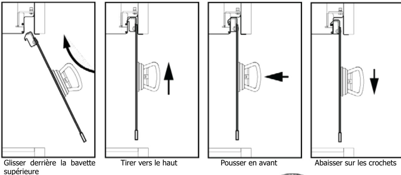
6. S'assurer visuellement que les crochets inférieurs reposent sur leurs tiges et que la vitre est de niveau et centrée dans l'ouverture.
