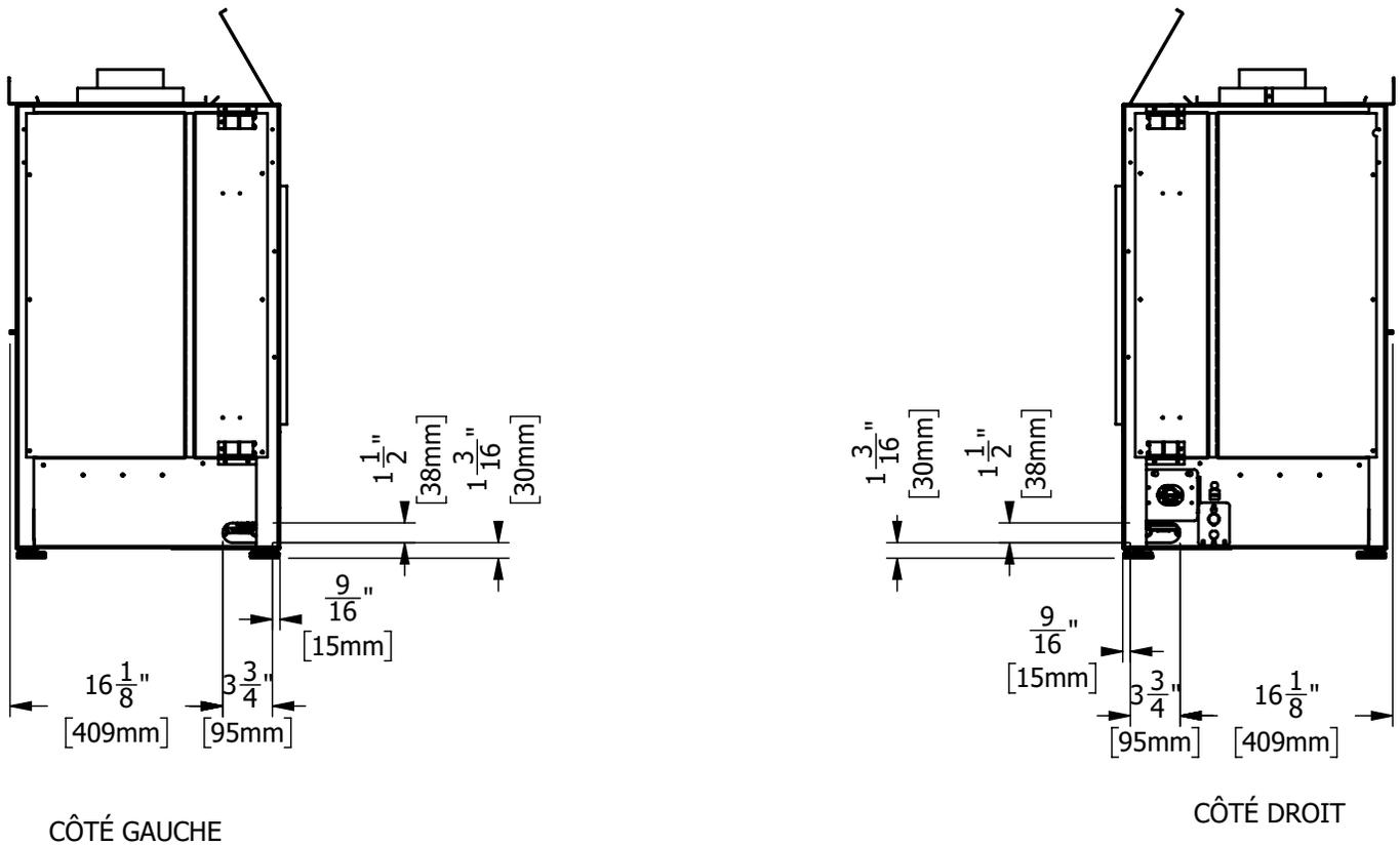
**Branchement électrique - bas de l'appareil**
