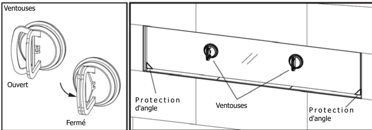
5. Tout en tenant l'écran vitré à l'avant de l'appareil, le faire glisser vers le haut derrière la bavette supérieure de l'appareil. Soulever l'écran au maximum puis l'accrocher sur l'appareil.
