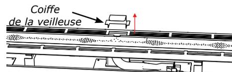
11. Retirer la garniture de recouvrement à la droite du brûleur en la soulevant. Retirer également le contour du brûleur en le faisant glisser vers la gauche et en le soulevant. Retirer également le diffuseur d'air perforé situé sur la droite du brûleur.
