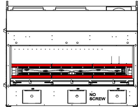
3. Placer les deux panneaux #2 dans la chambre de combustion aux extrémités gauche et droite, comme illustré ci-dessous.
