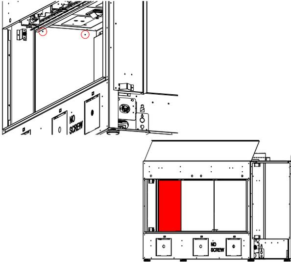
6. Nettoyer les panneaux à l'aide d'un chiffon. Ajouter les éléments décoratifs ou les bûches au besoin avant l'installation de la vitre intérieure de la chambre de combustion. Consulter le présent manuel pour les directives sur la façon d'installer la vitre de la chambre de combustion.
