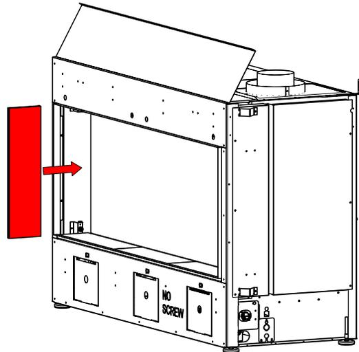
13. Nettoyer les panneaux externes à l'aide d'un chiffon avant d'installer la vitre extérieure de sécurité. Pour installer la vitre de sécurité, consulter le présent manuel pour les directives.
