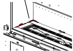
6. Faire glisser les trois panneaux vitrés arrière #4 dans les supports arrière et en angle inférieurs.
