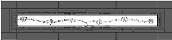
3. Placer les boulets de différentes tailles comme illustré ci-dessous. S'assurer qu'ils ne recouvrent aucun des orifices du brûleur.
