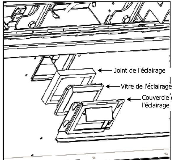
*Ordre de réassemblage des plaques intérieures de recouvrement de l'éclairage*
