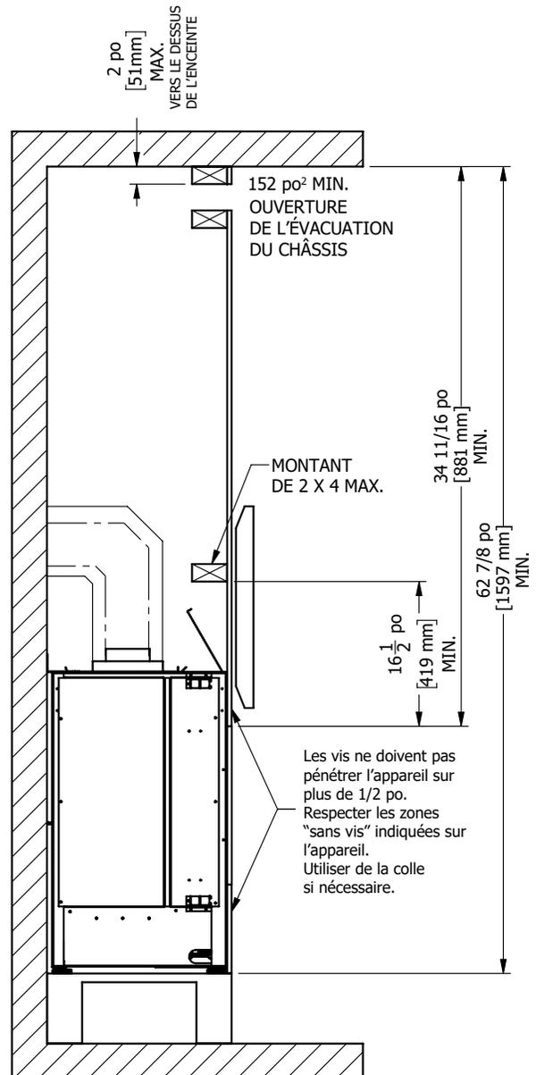
Remarque : Le support mural de la TV ne peut pas être fixé directement sur l'appareil. Il doit être fixé à l'encadrement. La TV illustrée sur ce schéma peut se trouver plus haut selon le type de support mural utilisé.
