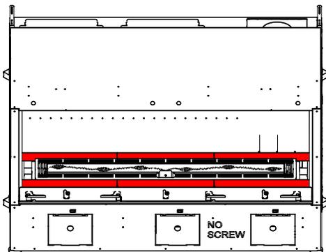
4. Mettre en place les 6 panneaux vitrés internes #2. Les panneaux vitrés doivent être placés sur les panneaux en acier. Installer les 2 panneaux latéraux internes en acier #3 aux extrémités du brûleur.
