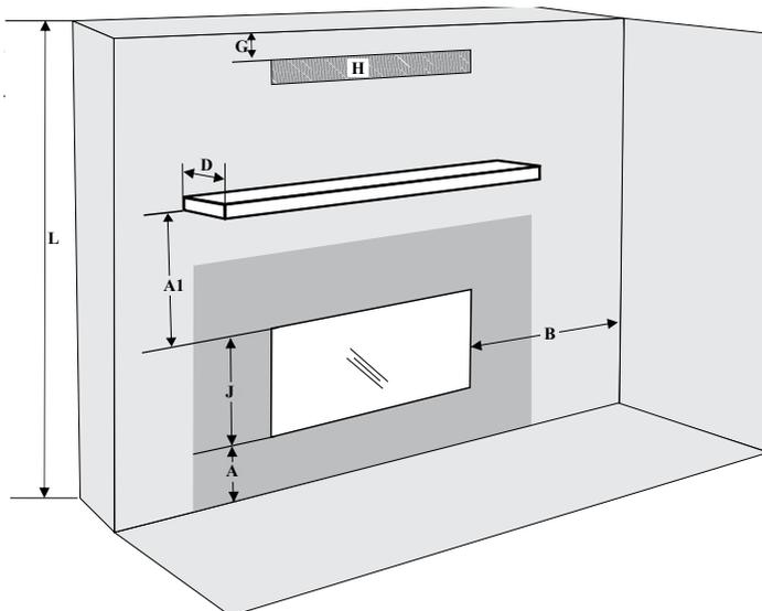
\*Une aire ouverte de 152 po<sup>2</sup> min. (981 cm<sup>2</sup>), placée à au moins 0-2 po au-dessus de l'enceinte du foyer, est requise pour toutes les installations.
