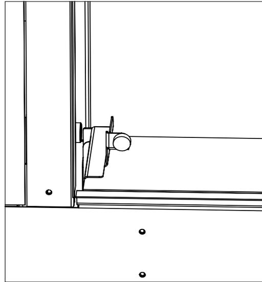
12. Faire glisser les panneaux vitrés latéraux externes #7 entre le mur et le support du butoir de la vitre. Si l'appareil n'est pas équipé d'un butoir, coller les panneaux latéraux externes sur les aimants.
