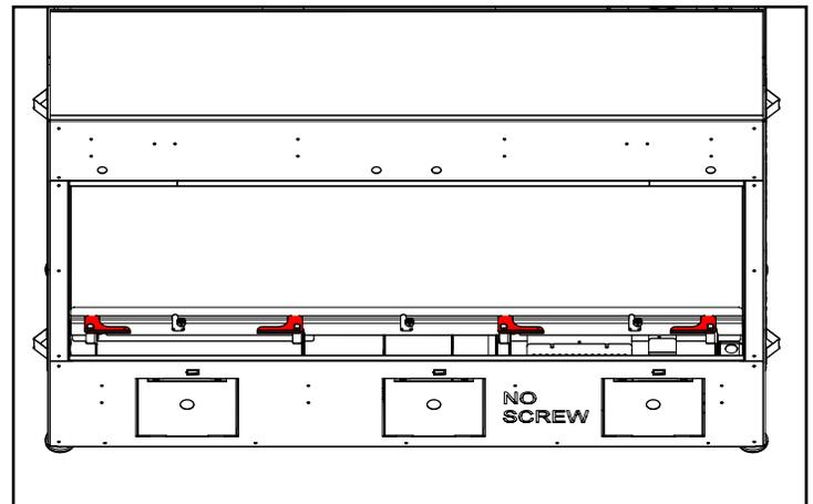
Attaches inférieures (x9) en position ouverte
