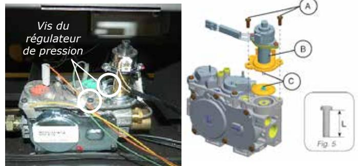
9. Rebrancher le câble du régulateur de pression qui a été débranché à l'étape 6 et replacer le module IFC en installant les vis qui maintiennent les ferrures de montage du module IFC.
