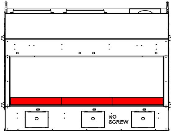
11. En option : installer le butoir de la vitre. Si l'appareil ne dispose pas de butoir, procéder à l'étape suivante.
