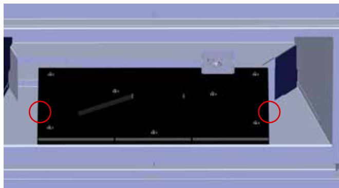
Schéma 3 - Emplacement des vis du brûleur
