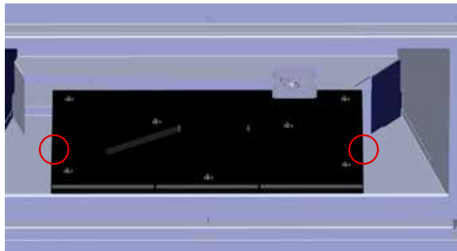
Schéma 3 - Emplacement des vis du brûleur
