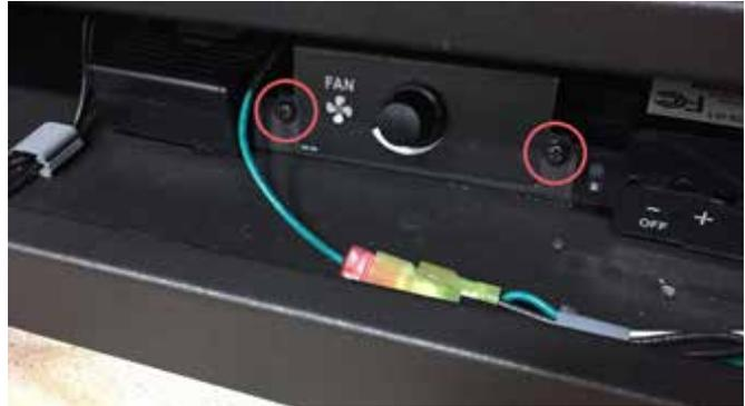
7. Installer le dispositif du ventilateur dans les tiges du plancher de l'appareil.
