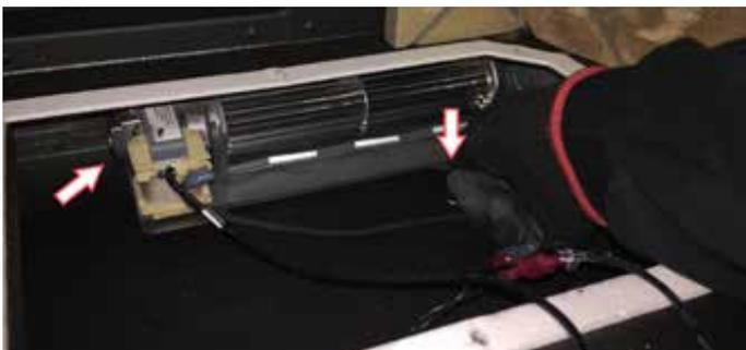
9. Fixer la cage du thermodisque au support situé sous le panneau d'accès du ventilateur.
