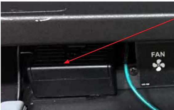
Retirer la porte du compartiment des piles pour installer ou remplacer la pile AA
