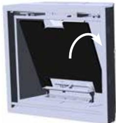
5. Desserrer les vis et retirer l'attache à briques.
