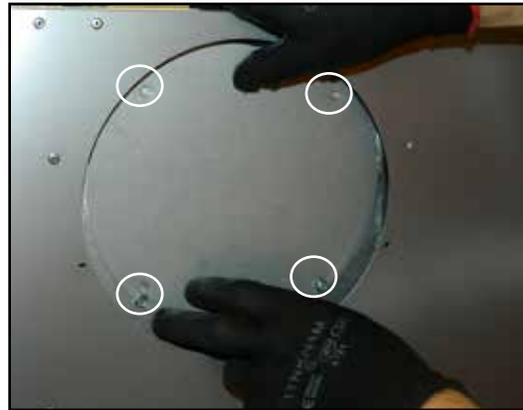
10. Installer la buse interne (retirée de l'arrière de l'appareil dans l'étape 3) sur le haut de l'appareil. Glisser la plaque sur les vis desserrées et serrer les six (6) vis supplémentaires.
