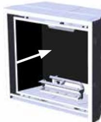
9. Glisser soigneusement le panneau inférieur sous le brûleur et le pousser vers l'arrière jusqu'à ce qu'il entre en contact avec le panneau arrière.
