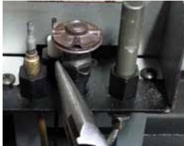
8. Retirer le capuchon de la veilleuse pour exposer l'orifice de la veilleuse.
