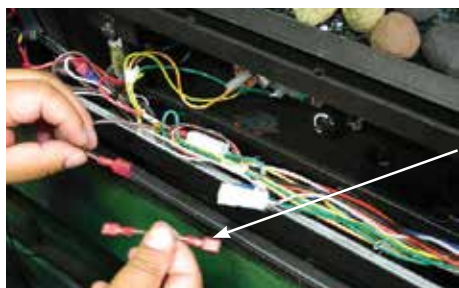
Mettre de côté le câble brun de 3 po
