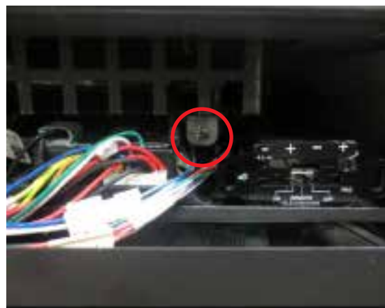
Le commutateur Surefire se trouve dans la partie inférieure droite, au-dessus du panneau DFC.
