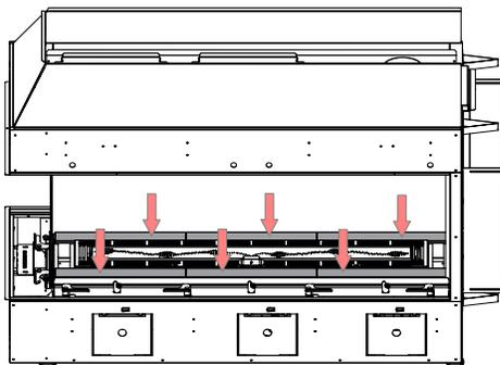
4. Insérer les 6 panneaux vitrés intérieurs #2. Les panneaux vitrés doivent se trouver au-dessus des panneaux en acier. Installer les 2 panneaux latéraux intérieurs en acier #3 à l'extrémité du brûleur.
