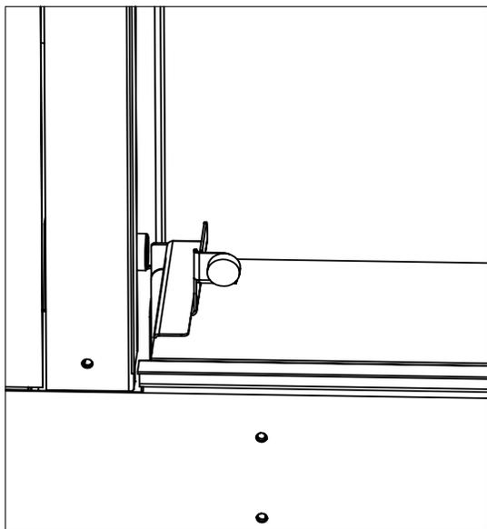
9. Faire glisser les panneaux extérieurs latéraux #6 entre le mur et le support du butoir de l'écran. Si l'appareil ne dispose pas de butoir, fixer les panneaux latéraux extérieurs aux aimants.
