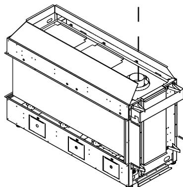
**Pour tout système d'évacuation rigide (sauf Simpson Dura-Vent), le conduit rigide doit être fixé à l'adaptateur à l'aide de 3 vis.**
