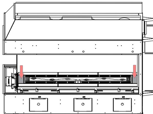
4. Installer les 2 vis sans les serrer sur les côtés de la boîte à feu et placer le panneau latéral #3 sur les côtés de la chambre de combustion, comme indiqué ci-dessous.
