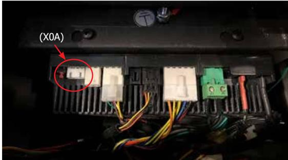
4. Aligner les languettes situées sur la clé avec les fentes du raccordement du panneau IFC et insérer le câble dans le raccordement.
