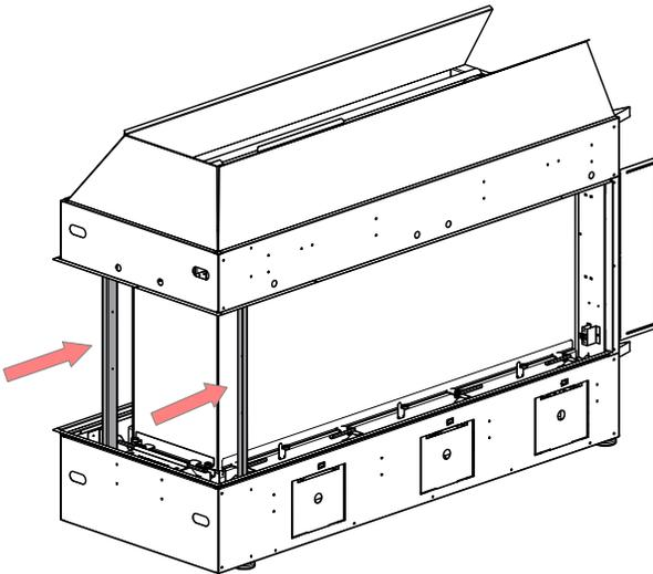
2. Retirer les panneaux vitrés des côtés A et B de la chambre de combustion.
