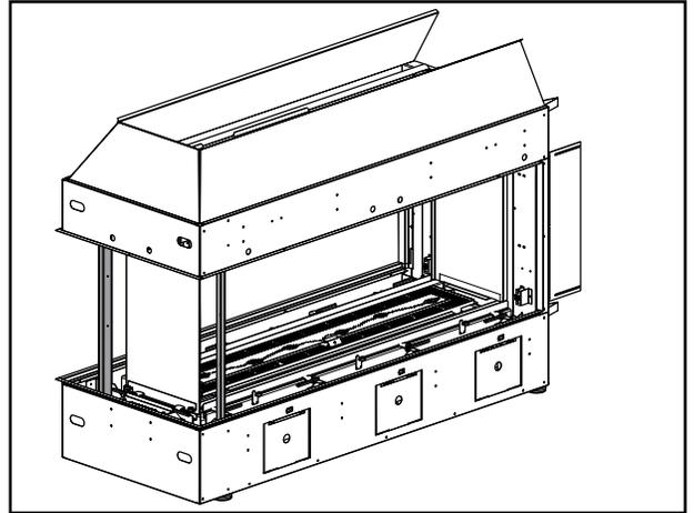
3. Localiser le support qui retient les pinces de l'extrémité inférieure et desserrer les deux vis pour retirer le support.
