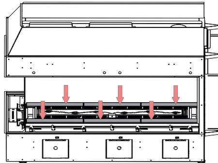
3. Placer les deux panneaux #2 dans la chambre de combustion sur les côtés gauche et droit, comme indiqué ci-dessous.
