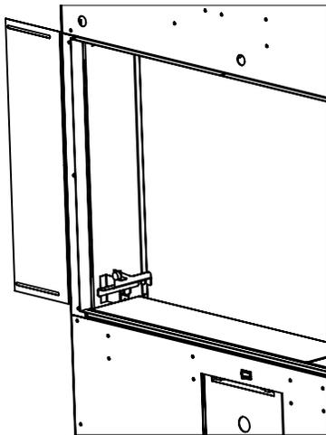
8. Faire glisser les panneaux extérieurs latéraux #5 entre le mur et le support du butoir de l'écran. Répéter les étapes pour installer les trois autres panneaux extérieurs #5 en utilisant un butoir de l'écran si nécessaire.
