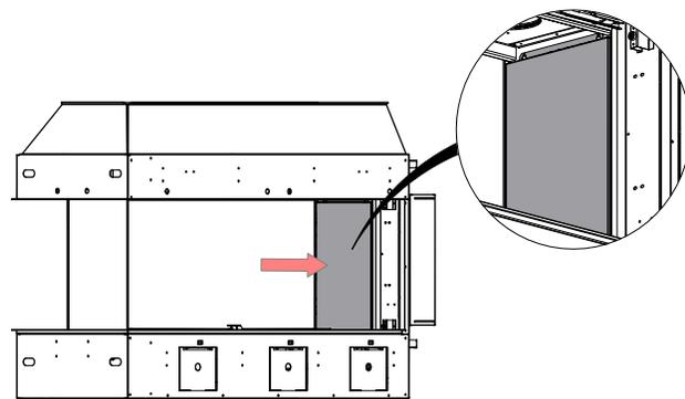
4. Nettoyer les panneaux avec un chiffon. Ajouter les éléments décoratifs ou les bûches désirés avant d'installer la vitre intérieure de la chambre de combustion. Consulter ce manuel pour savoir comment installer la vitre de la chambre de combustion.
