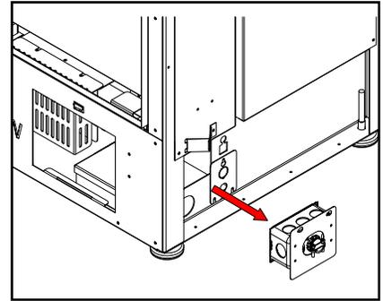
3. Faire glisser la plaque du boîtier électrique vers l'arrière de l'appareil, puis vers l'extérieur.
