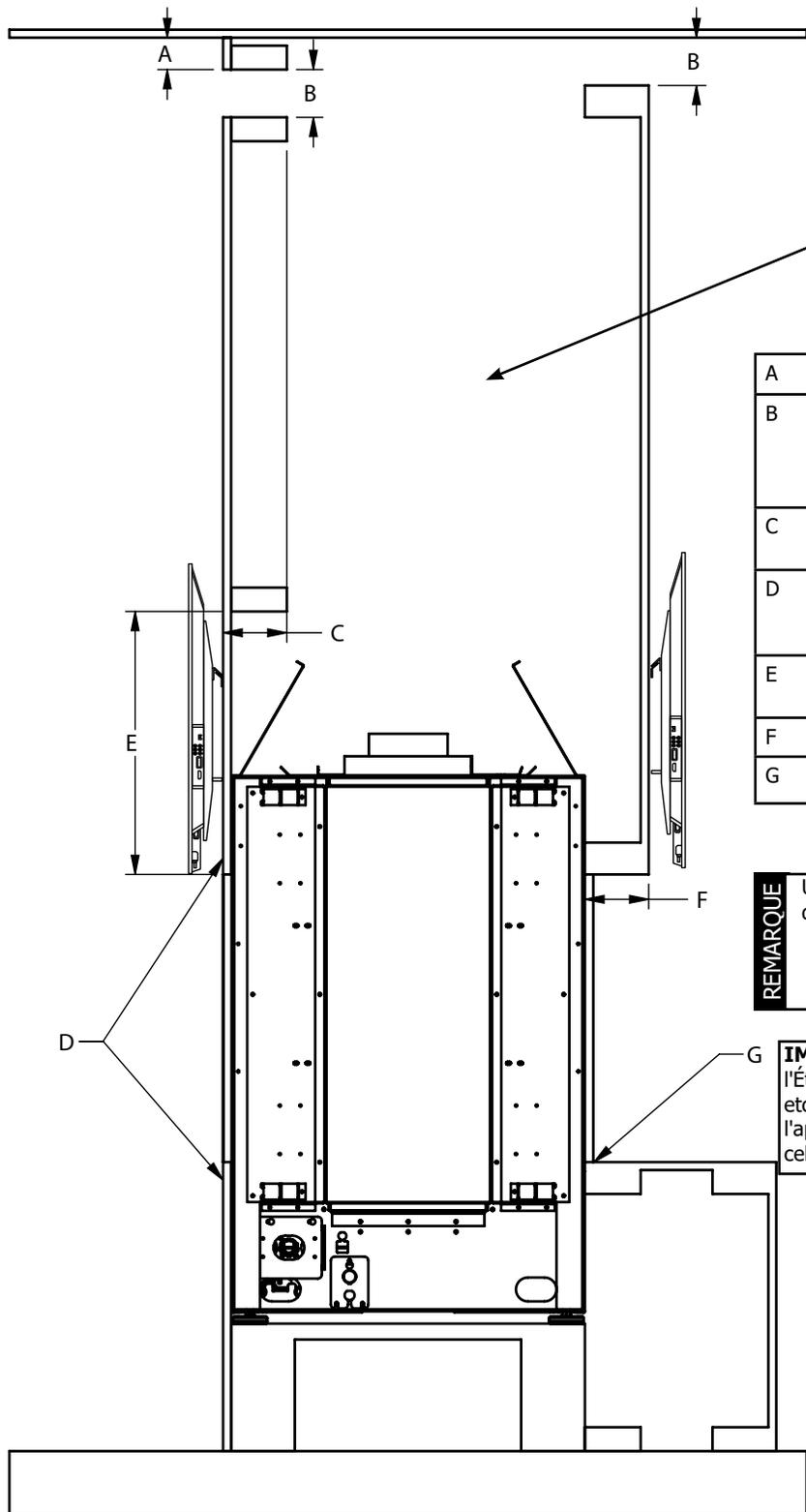
**Important :** L'enceinte du châssis doit être complètement ouverte à pleines largeur, hauteur et profondeur au-dessus de l'appareil conformément aux exigences indiquées dans la section sur l'encadrement pour les installations en banc et affleurantes.
