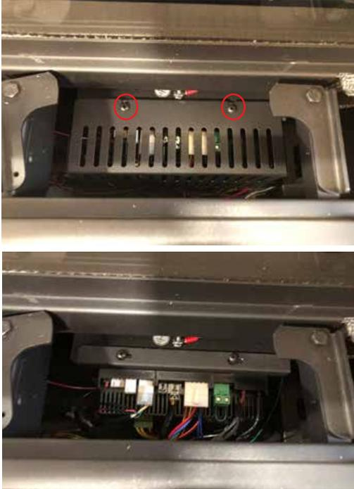
3. Localiser le raccordement de la clé électronique WiFi (X0A) sur le côté gauche du panneau IFC.
