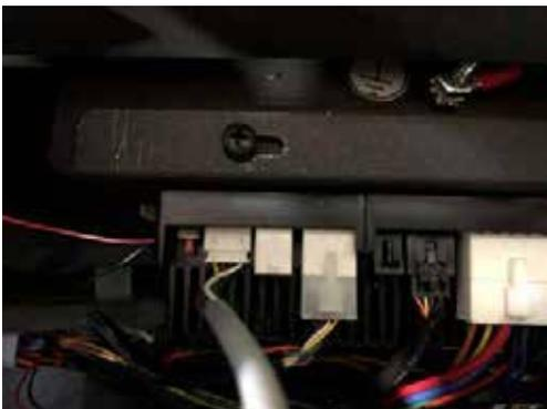
5. Localiser le porte-clé électronique sur la droite du panneau IFC. S'il n'y a aucun porte-clé, apposer les attaches en Velcro fournies sur la clé et fixer la clé sur le support de fixation le plus proche au niveau du panneau IFC.
