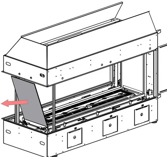
8. Refaire le processus en sens inverse pour réinstaller le panneau vitré de l'extrémité de la chambre de combustion.
