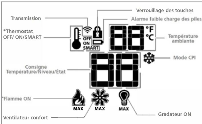
Schéma 1 : Afficheur LCD de la télécommande
