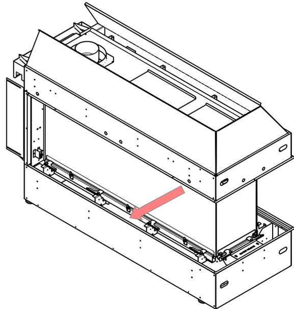
Les supports de transport peuvent être placés à l'intérieur de l'appareil.
