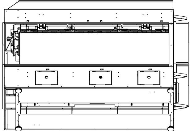
Une fois les attaches supérieures en position ouverte, utiliser les mains pour tirer les deux rails du joint d'étanchéité de la vitre vers soi.
