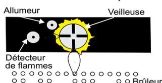
**REMARQUE** Si le réglage de la flamme n'est pas correct, contactez votre détaillant Regency® pour de plus amples instructions.
