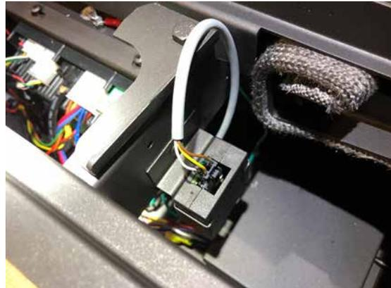
7. Réinstaller le couvercle du panneau IFC et serrer les 2 vis.
