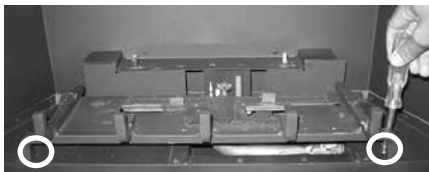
Retirer les 2 vis, pousser le brûleur vers la gauche et le soulever pour le sortir.
