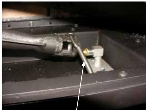
Câble de réglage de l'arrivée d'air
