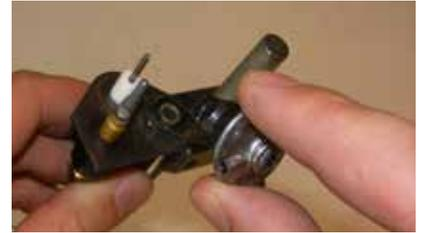
15. Dévisser l'orifice de la veilleuse à l'aide de la clé hexagonale et le remplacer par le nouvel orifice à propane inclus dans la trousse.
