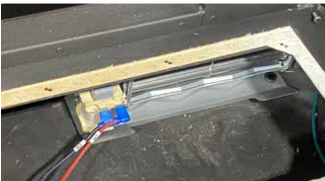
9. Fixer la cage du thermodisque au support situé sous le panneau d'accès du ventilateur.
