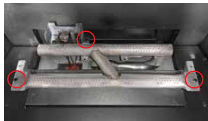
Schéma 2 - Faire glisser le dispositif du brûleur vers la droite, puis le retirer.
