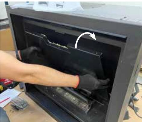
5. Desserrer les vis et retirer l'attache à briques.
