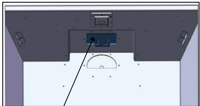
Schéma 2: Réducteur de débit d'air localisé sur le dispositif d'évacuation supérieur.
