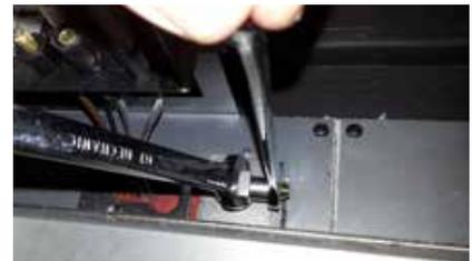
13. Placer le bouton de commande sur la position "OFF". Localiser le bouton "Hi/Lo" sur la valve de gaz. Voir le schéma ci-dessous.
