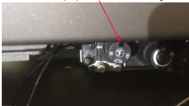
Extendeur glissé sur le bouton on/off/veilleuse sur la valve à gaz
