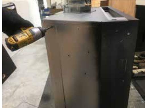
7. Desserrer les deux vis les plus à l'extérieur auxquelles on accède par les trous dans les emplacements indiqués ci-dessous. REMARQUE : Ne pas retirer ces deux vis mais les desserrer.
