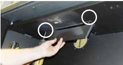
3. Desserrer les deux vis sur le dispositif de la veilleuse dans les emplacements indiqués ci-dessous. Glisser la protection de la veilleuse vers le mur du fond puis le retirer de l'appareil.
