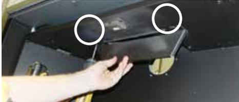
3. Desserrer les deux vis sur le dispositif de la veilleuse dans les emplacements indiqués ci-dessous. Glisser la protection de la veilleuse vers le mur du fond, puis le retirer de l'appareil.
