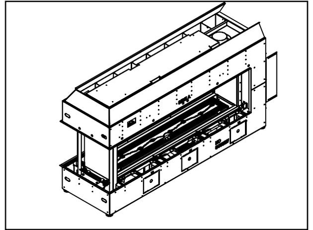
3. Localiser le support qui maintient les pinces de l'extrémité inférieure et desserrer les deux vis pour retirer le support.
