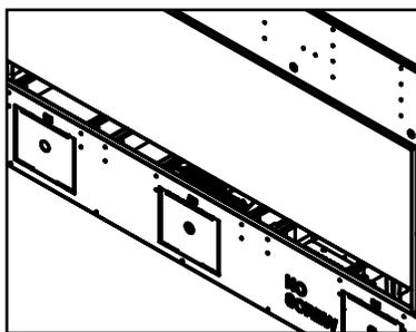
2. Depuis l'intérieur de l'appareil, pousser la languette vers l'intérieur pour dégager le panneau d'accès sur le dessus.
