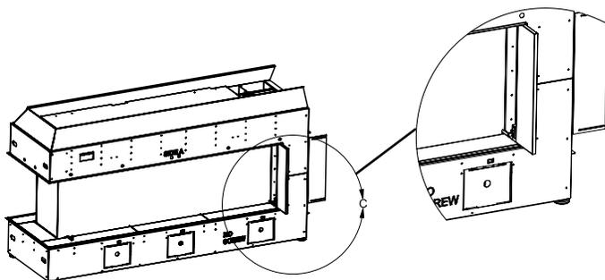
9. Installer les butoirs supplémentaires de la vitre au bout de l'appareil en faisant glisser l'ensemble des butoirs entre l'appareil et le panneau : cet ensemble se fixe à l'appareil avec un aimant, ajuster la position du butoir si nécessaire.
