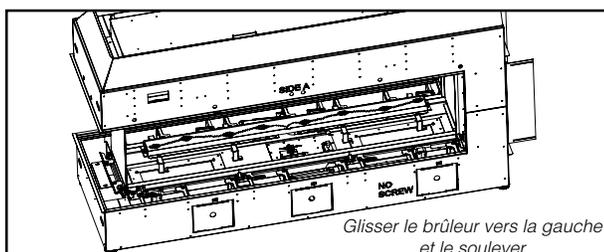
13. Enlever l'orifice du brûleur à l'aide d'une clé de 3/8 po. Utiliser une autre clé pour tenir le coude derrière l'orifice. Réinstaller le nouvel orifice du brûleur pour propane n° 50 et le serrer.
