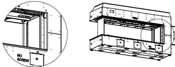
5. Nettoyer les panneaux à l'aide d'un linge. Ajouter les éléments décoratifs ou les bûches souhaités avant d'installer la vitre intérieure de la chambre de combustion. Voir le présent manuel pour les consignes.
