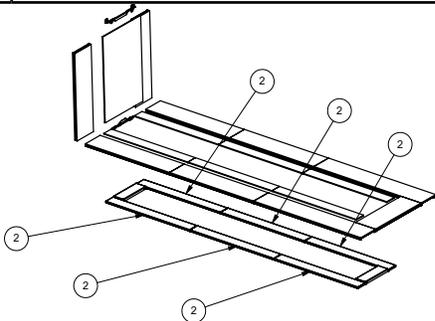
3. Placer les six panneaux intérieurs n° 2 dans la chambre de combustion, 3 de chaque côté du brûleur comme indiqué ci-dessous.
