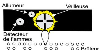
Si le réglage n'est pas correct, les flammes sont petites et certainement jaunes, et n'entrent pas correctement en contact avec le brûleur arrière ou le détecteur de flammes.
