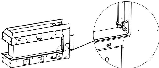
8. Faire glisser les panneaux extérieurs n° 5 entre la paroi et le support de l'écran. Répéter les étapes pour installer les autres panneaux extérieurs n° 5 à l'aide d'un bloc-écran si nécessaire.
