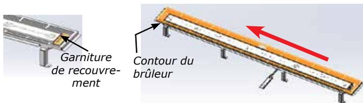
7. Dévisser 8 vis dans les emplacements indiqués ci-dessous (2 à l'avant et 2 à l'arrière) — faire glisser le brûleur sur la gauche, en l'écartant de l'orifice puis le soulever.
