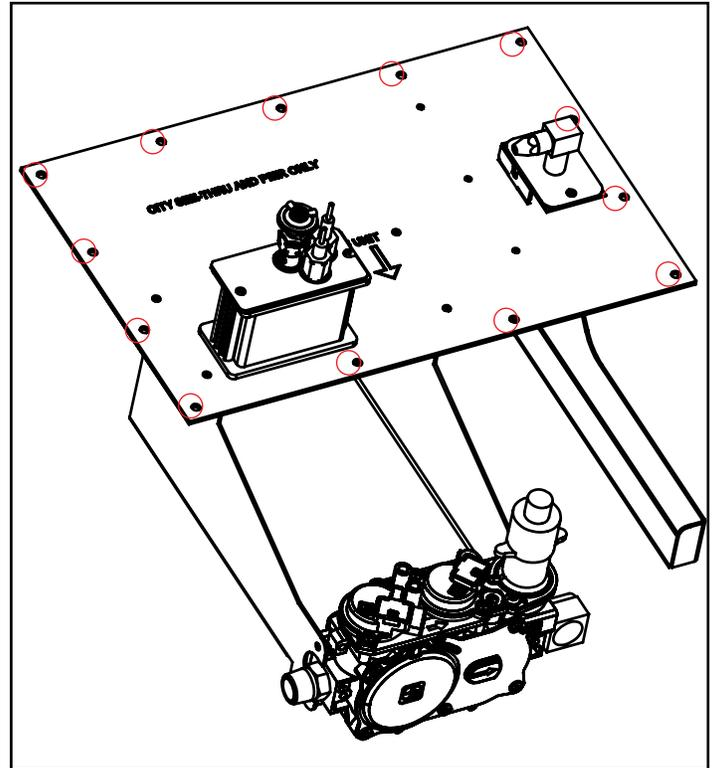
10. Soulever partiellement le plateau de la valve et débrancher la conduite flexible de gaz située sur le côté de l'entrée de la valve. Retirer le plateau de la valve et le remplacer par un nouveau plateau.
