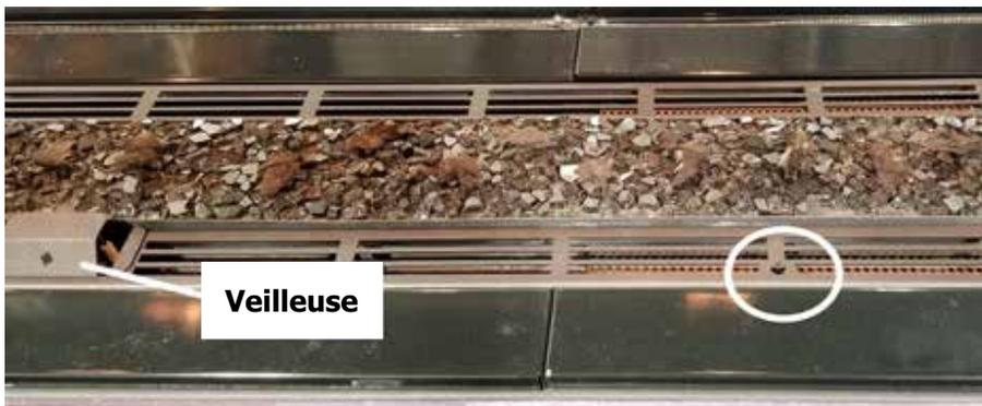
9. Insérer la tige de la bûche 2 dans le trou. Poser la bûche sur la chambre de combustion, puis mesurer du bord de la bûche au côté, comme indiqué ci-dessous.
