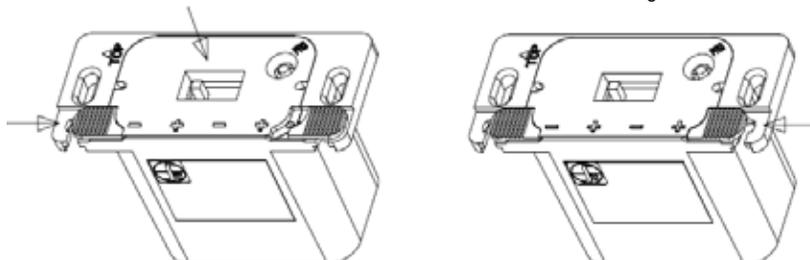
ÉTAPE 4 Réinstaller la plaque de recouvrement du mur à l'aide de 2 vis à tête Phillips.
