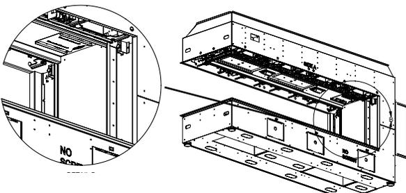
3. Placer les six panneaux intérieurs n° 3 dans la chambre de combustion, puis les deux couvercles latéraux n° 2, comme illustré ci-dessous.
