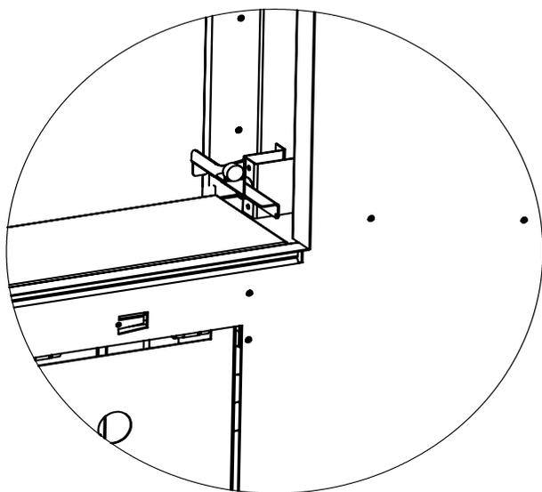
11. Faire glisser les panneaux extérieurs n° 5 entre la paroi et le support de l'écran. Si l'appareil n'a pas de butoir, fixer les panneaux latéraux extérieurs aux aimants. Répéter les étapes pour les 3 côtés restants.
