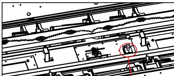
14. Retirer la pince de retenue de la veilleuse à l'aide d'une paire de tenailles et enlever la coiffe de la veilleuse pour dégager l'orifice de la veilleuse.
