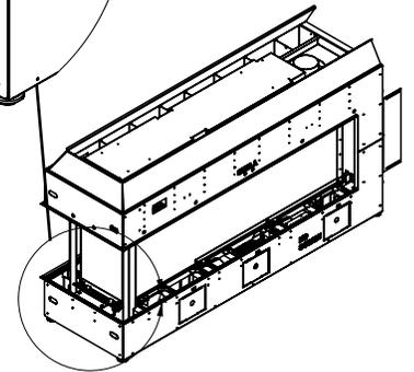
4. Repérer les deux supports qui maintiennent les pinces de l'extrémité supérieure et retirer les vis pour enlever les supports.
