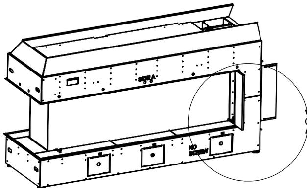
12. Installer les butoirs supplémentaires de la vitre à l'extrémité de l'appareil en faisant glisser l'ensemble des butoirs entre l'appareil et le panneau : cet ensemble se fixe à l'appareil avec un aimant, ajuster la position du butoir si nécessaire.
