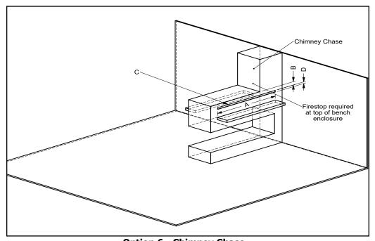
10" (254 mm) min. 2" (51 mm) min. С 180 sq. in min. 1-1/2" (38 mm) min.
