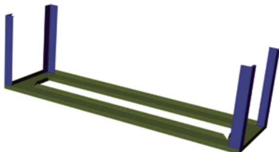
Schéma 1 - Supports d'angle sur le cadre inférieur.
