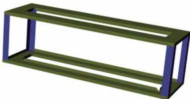
Schéma 3 - Supports d'angle avec cadre supérieur
