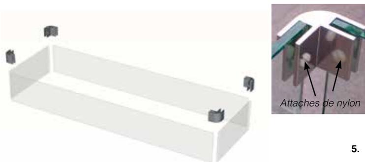
3. À l'aide d'un tournevis plat, serrer les 4 ferrures d'angle supérieures avec les attaches de nylon dans chaque angle. La ferrure doit être affleurante à la partie supérieure de la vitre, comme illustré ci-dessous.
