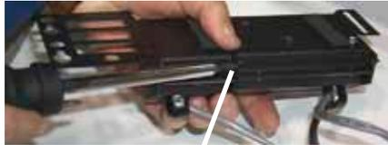
9) Placer le module ainsi formé sur la grille inférieure et marquer la position de la fente de la ferrure droite.
