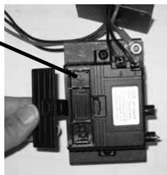
32) Glisser l'écran thermique sur le dispositif d'allumage et fixer le tout en place à l'aide du velcro fourni.
