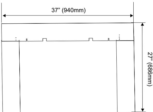
Modèle CI1205 sur mesure - Dimensions minimales
