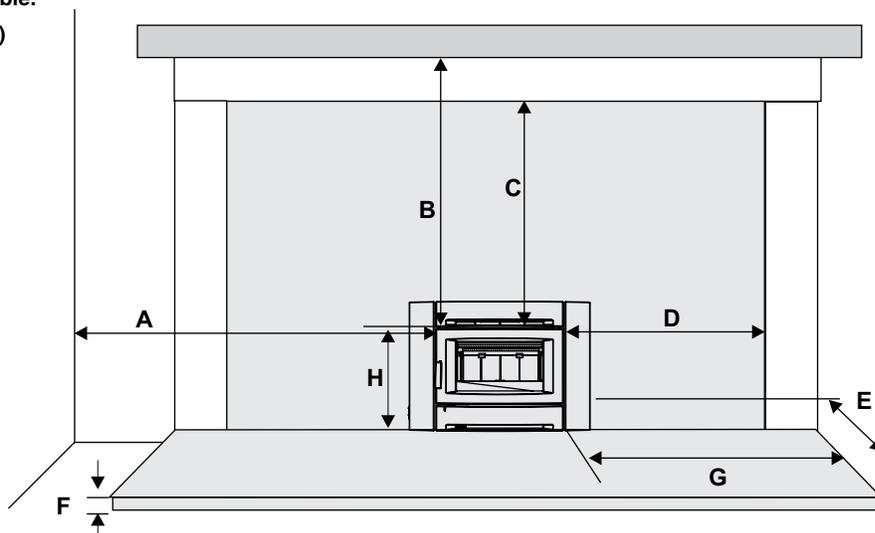
Schéma des dégagements de l'installation
