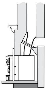
2) Raccordement direct de cheminée avec trappe de nettoyage
