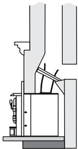
1) Raccordement de cheminée positif avec trappe de nettoyage
