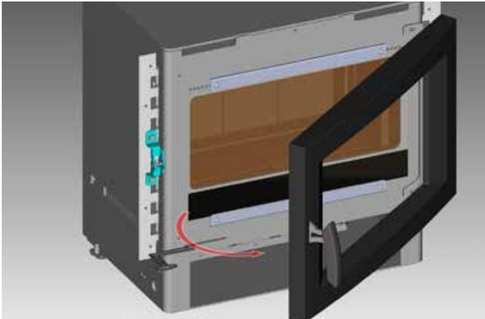
**REMARQUE :** Utiliser des matériaux non combustibles et ajuster les boulons de nivellement de 1/2 po à 1 po pour régler le niveau d'un appareil encastré dans l'âtre d'un foyer en maçonnerie.
