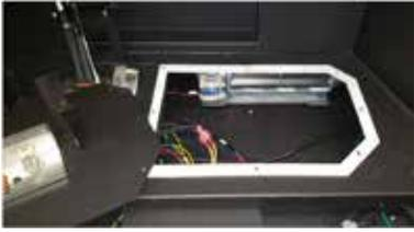
10. Desserrer 2 vis du boîtier IFC et les mettre de côté.
