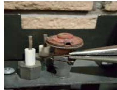
10. Retirer le capuchon de la veilleuse pour exposer l'orifice de la veilleuse.
