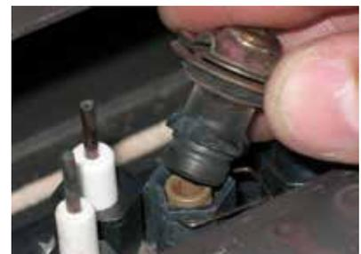
11. Dévisser l'orifice de la veilleuse à l'aide de la clé Allen, puis le remplacer avec l'orifice de la veilleuse au propane, fourni dans la trousse.
