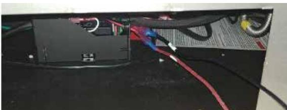
5. Raccorder le câble de mise à la terre du ventilateur à la prise de terre (située dans le coin inférieur droit de l'appareil). Se reporter au schéma de câblage.
