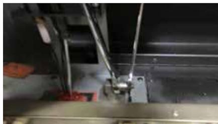
8. Réinstaller le nouvel orifice du brûleur au propane estampillé n° 51 et le serrer.
