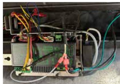
13. Repérer le raccordement de la clé X0A sur le module IFC.
