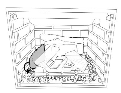
8. Placer la bûche 3 sur l'axe et la faire tourner jusqu'à ce qu'elle touche la languette indiquée ci-dessous. S'assurer que la bûche 3 repose directement sur le plateau, sans braises en dessous.
