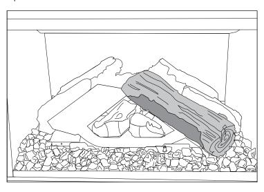
18. Placer la bûche 7 sur la gauche du brûleur. La bûche doit reposer sur le brûleur.
