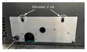
Retirer la vis qui fixe le panneau IFC et tirer le panneau IFC pour le dégager et accéder au faisceau électrique principal.
