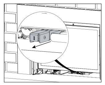
2. Tourner la valve à gaz sur la position souhaitée. Si nécessaire, utiliser un tournevis à tête plate.
