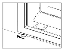
Lorsque la veilleuse est allumée, tourner l'interrupteur vers la droite pour allumer le brûleur. En déplaçant l'interrupteur vers la gauche, le brûleur s'éteint.
