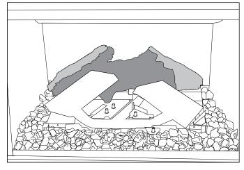
13. Placer la bûche 2 à l'arrière de la partie gauche du brûleur, en faisant reposer son côté droit sur l'entaille située sur la bûche 1. Faire tourner l'avant de la bûche 2 sur la bride de fixation en métal et s'assurer qu'elle repose directement sur le plateau, sans braises au-dessous.
