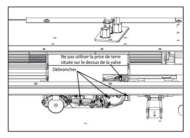
6. Faire glisser le plateau IFC pour le dégager et débrancher les fils de la veilleuse et le fil du moteur.
