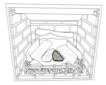
11. Placer la bûche 6 sur la grille, l'encoche du milieu de la bûche reposant sur le premier barreau de la grille et la partie plate pointant vers le haut. La bûche 6 ne repose pas sur le panneau avant : elle repose sur la languette située à côté du deuxième barreau de la grille. Vérifier qu'il n'y a pas de braises sous la bûche.
