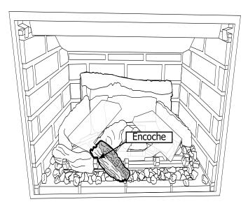
13. Placer la bûche 8 entre le troisième et le quatrième barreau de la grille. La partie carbonisée au sommet de la bûche est orientée vers l'intérieur de la chambre de combustion.
