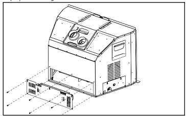
3. Retirer le panneau d'accès électrique du côté gauche de l'encastrable en enlevant les cinq vis.
