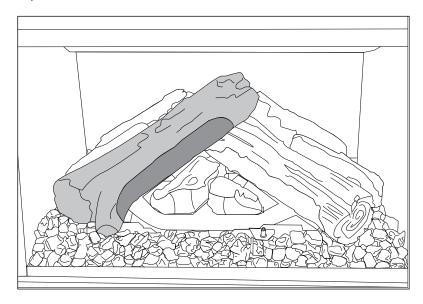
19. Placer la bûche 8 sur la tige située sur le support de bûches avant. L'autre extrémité doit reposer sur les braises.
