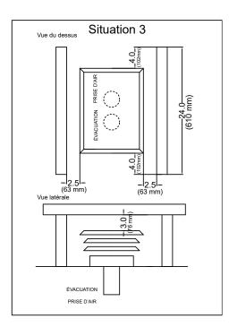
Remarque: Le réducteur de débit d'air doit être ouvert à 2-1/2 po (63 mm) pour le gaz naturel ou à 4-1/2 po (114 mm) pour le propane.
