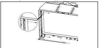
1. Fixer les supports sur les deux côtés à l'aide des quatre vis fournies, en veillant à ce qu'ils se trouvent à l'avant des fentes.
