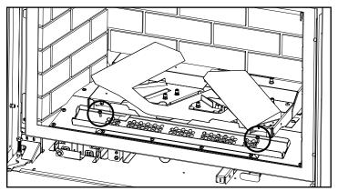
3. Soulever la plaque de recouvrement de l'éclairage pour la retirer.
