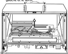
8. Retirer l'orifice du brûleur à l'aide d'une clé de 1/2 po et le remplacer par l'orifice n° 52 qui se trouve dans la trousse.
