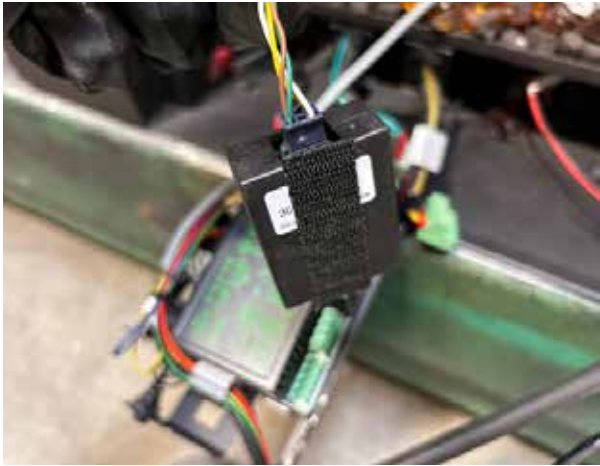
Schéma 6 Velcro apposé à la clé Wifi
