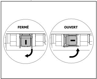
Il est aussi possible de tourner le bouton pour le transformer en poignée et obtenir un meilleur effet de levier. Le sens des aiguilles d'une montre ferme la valve, le sens inverse l'ouvre.
