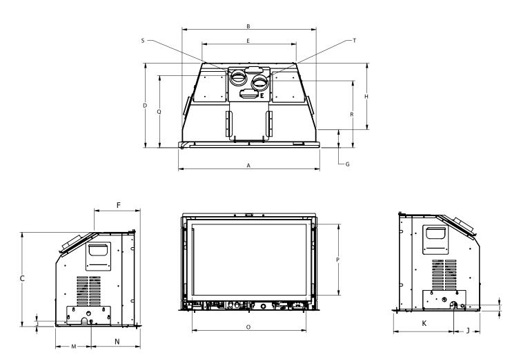
Remarque : Le branchement du gaz se trouve sur la droite de l'appareil et le branchement électrique sur la gauche de l'appareil.
