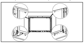
3. Fixer quatre vis sur les deux côtés pour attacher la plaque de sup-
