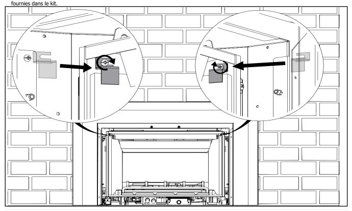
9. Installer les panneaux avant\* entre le plateau de support et l'avant de la chambre de combustion. Si le panneau avant est trop serré, des fentes de réglage sur le plateau de support permettent de le desserrer. Desserrer les deux vis du plateau de support et le faire glisser vers l'arrière ou l'avant selon les besoins. Serrer les vis une fois que le plateau de support est à l'emplacement souhaité.
