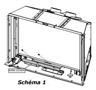
1b. Retirer le couvercle situé sur la gauche (desserrer les deux vis supérieures et soulever le couvercle pour le sortir).
