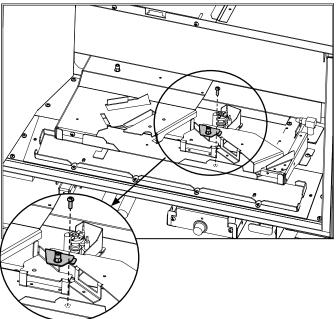
8. Réinstaller le brûleur et la protection de la veilleuse.
