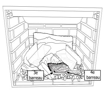
14. Placer la bûche 9 à l'extrémité droite du brûleur. La bûche repose sur le brûleur, et non sur le cinquième barreau de la grille.
