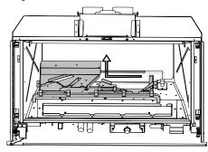
Tirer le capuchon de la veilleuse pour dégager l'orifice de la veilleuse.
