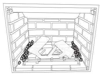
5. Répartir les braises noires/blanches le long des panneaux frontaux. Lorsque les bûches 6, 7 et 8 sont installées, vérifier que les braises n'empêchent pas de placer correctement les bûches. Il est également possible d'ajouter les braises après avoir placé toutes les bûches.
