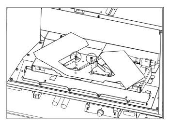
6. Retirer le brûleur en faisant glisser le côté gauche pour le soulever et le dégager du plateau du brûleur.
