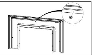
7. Soulever la façade et le contour traditionnel depuis les emplacements indiqués sur le schéma ci-dessous et se réferer à la section "Installation de la façade / de la bordure de finition".
