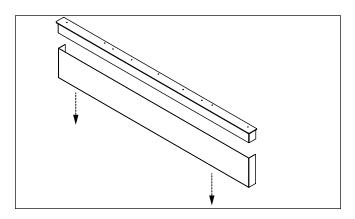
2. <u>Si une meuleuse est utilisée (recommandé)</u>: Couper la section inférieure à hauteur, en se référant au tableau d'installation pour déterminer la quantité à enlever.
