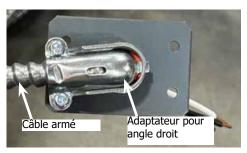
10. Installer le support dans le couvercle latéral. Avant l'installation, deux trous pourraient être percés à l'aide d'une point de 1/8 po en utilisant le support comme modèle.
