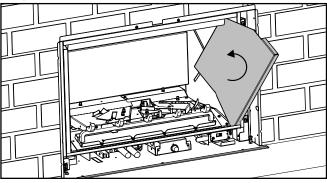
8. Installer les clips de retenue des briques et serrer les vis. Remarque : L'ensemble de panneaux vitrés (311-906) dispose de ses propres retenues
