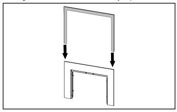
Soulever la façade et le contour de la façade à partir du bord supérieur et se reporter à la section "Installation de la façade et de la bordure de finition".
