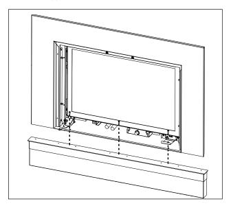
2b. Avec un contour haut de gamme : Faire glisser la garniture d'âtre aussi loin que possible vers l'arrière (en veillant à ne pas la rayer) et serrer les vis.
