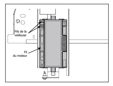
REMARQUE : Les fils doivent être sécurisés par des attaches grises au moment de la réinstallation.
