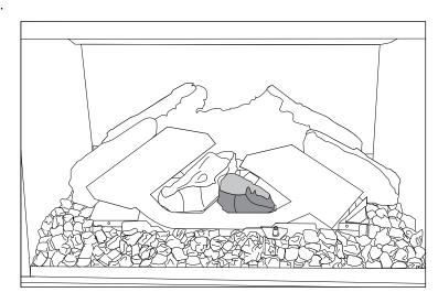
17. Placer la bûche 6 sur l'extrémité droite du brûleur. La bûche doit reposer sur le brûleur.
