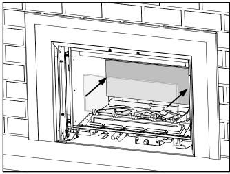
Les ensembles de panneaux de briques doivent être installés avec la flèche à l'arrière du panneau pointant vers le haut pour aligner les lignes de coulis.
