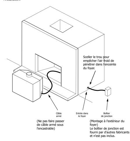
REMARQUE : Modèle illustré avec câble armé situé sur la droite. Selon le modèle ce câble peut se trouver sur la gauche.
