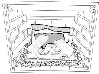
7. Placer la bûche 2 derrière la partie gauche du brûleur, en posant son côté droit dans la zone encochée de la bûche 1. Faire pivoter l'avant de la bûche 2 sur la bride métallique et s<sup>T</sup>assurer qu'elle repose directement sur le plateau, sans braises en dessous.
