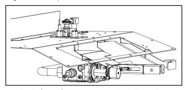
10. Refaire les étapes 9 à 1 en sens inverse pour la remplacer par le nouveau dispositif de la valve.
