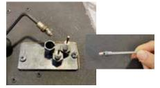
10. Retirer l'orifice du brûleur à l'aide d'une clé de 1/2 po et le remplacer par l'orifice n° 52 qui se trouve dans la trousse. Utiliser une autre clé pour maintenir le coude à l'arrière au moment du retrait ou du remplacement de l'orifice du brûleur.
