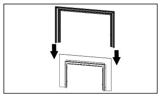
6. Insérer et serrer les vis arrière (x5). Le contour traditionnel est installé.
