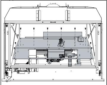
9. Retirer les 2 vis de chaque côté de la valve et débrancher la conduite de gaz de la veilleuse pour enlever la valve.
