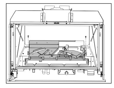
4. Retirer le plateau d'éclairage en enlevant les 12 vis et en débranchant le plateau d'éclairage situé en dessous.
