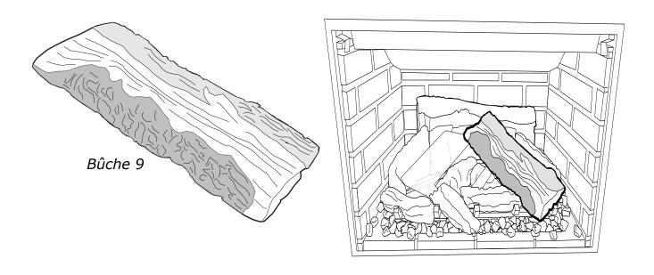
15. Placer la bûche 10 sur le côté gauche du brûleur. La bûche 10 ne doit pas toucher la bûche 6. Réajuster le positionnement de la bûche 6 si nécessaire, en s'assurant qu'elle repose sur la languette à côté du deuxième barreau de la grille.
