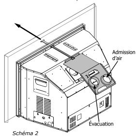
S'assurer que le coupe-tirage est correctement fixé et que les vis sont serrées pour créer une étanchéité adéquate.
