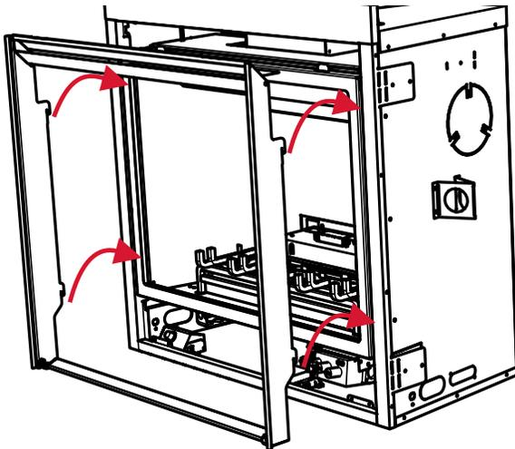
2. Aligner les ferrures sur la grille avec les fentes situées sur le cadre extérieur et baisser doucement la grille pour la mettre en place. Rapprocher le bas de la grille vers l'avant de l'appareil jusqu'à ce qu'il fasse contact avec les aimants.
