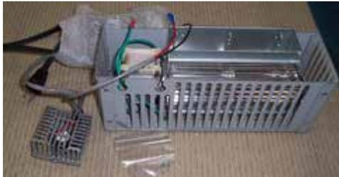
4. Brancher le câble **noir** à la borne de gauche du moteur du ventilateur. Glisser le câble noir et le fil de masse vert dans le serre-câble et pousser le serre-câble dans le logement du ventilateur.
