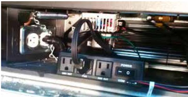
11. Brancher le câble d'alimentation du ventilateur au module de commande du ventilateur dans la prise marquée "Fan". Brancher le câble FCM-COM du faisceau de câblage de la télécommande dans l'emplacement sur le module de commande du ventilateur marquée "COM". Mettre l'interrupteur sur le module de commande du ventilateur sur "ON", sur la gauche. Le "O" est la position d'arrêt ("OFF").
