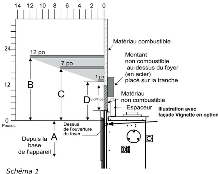
**Remarque :** Fixer le panneau non combustible directement sur l'appareil comme illustré ci-dessus. Installer un montant en acier directement sur l'appareil comme illustré ci-dessus, afin de maintenir le matériau non combustible en place.
