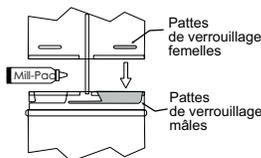
**REMARQUE : Pour de meilleurs résultats et une performance optimale d'un système d'évacuation homologué, il est vivement recommandé d'appliquer du scellant Mill-Pac (fourni) sur la partie intérieure de chaque raccord de conduit. Le non-respect de cette procédure peut causer des problèmes de tirage ou de performance qui ne sont pas couverts par la garantie.**
