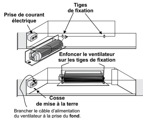
8. Connecter le fil de mise à la terre du ventilateur à la tige de mise à la masse.
