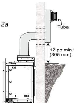
\* Schéma 2a : Comme spécifié dans le code d'installation CSA B149.1. Les dégagements peuvent varier selon les codes et règlements locaux.
