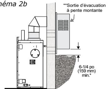
\*\* Remarque : La terminaison à pente montante est uniquement destinée à être utilisée pour les terminaisons au niveau du sol.
