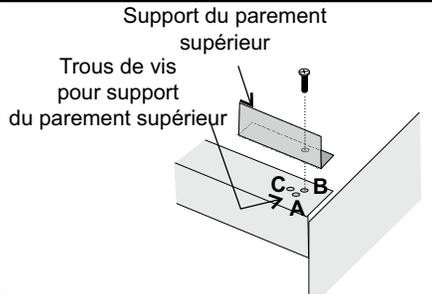
Le support du parement supérieur est inversé pour l'emplacement du trou C.
