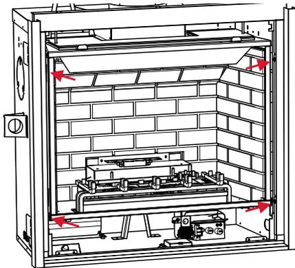
3. Dévisser les 3 vis sur le rebord supérieur interne de la chambre de combustion.
