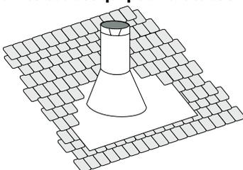
*Schéma 3 : Installer la portion supérieure du solin au-dessus des matériaux de toiture et ne pas la fixer avant l'installation du conduit de cheminée. De petits ajustements pourront ainsi être effectués par la suite.*
