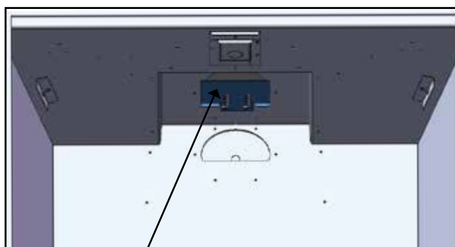
Schéma 2 : Réducteur de débit d'air localisé sur le dispositif d'évacuation supérieur.
