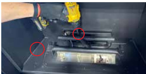
Schéma 2 : Glisser le brûleur vers la droite et l'enlever
