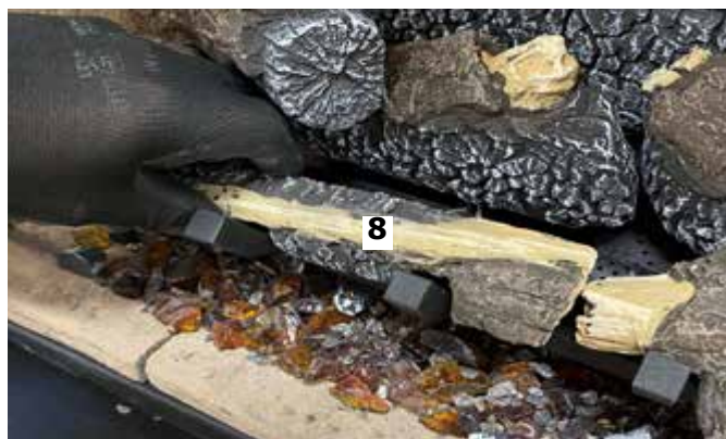
Schéma 13 - Installation de la bûche 8
