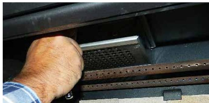
9. Dévisser les boulons sur la rainure de retenue du catalyseur, puis faire glisser la rainure de retenue du catalyseur vers la droite pour la sortir.
