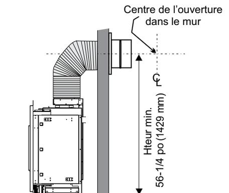
**REMARQUE :** L'installation d'une section verticale d'au moins 1 pi (305 mm) est requise avant l'installation de toute section horizontale.
