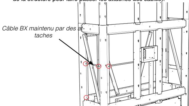
6. Faire courir le câble BX vers le bas, à l'arrière de l'appareil en l'amenant vers le boîtier électrique situé sur la partie inférieure avant gauche de l'appareil, puis raccorder au 120V.
