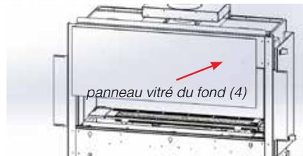
9. Une fois le panneau du fond installé, glisser l'un des panneaux latéraux (6) en place. Pousser le panneau au fond de la chambre de combustion en s'assurant que la vitre repose sur la fixation du coin inférieur installée à l'étape 4. Fixer la fixation arrière supérieure comme illustré ci-dessous. Remarque : Il y a une fixation à gauche et à droite. La fixation de gauche est illustrée ci-dessous.
