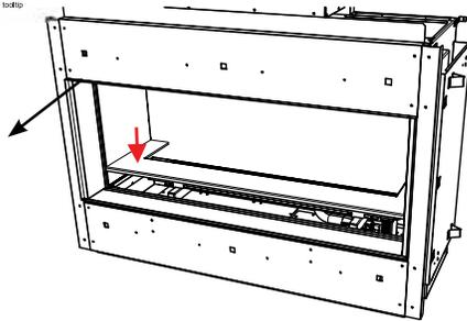
2. Mettre en place le panneau du fond sur la paroi du fond de l'appareil.
