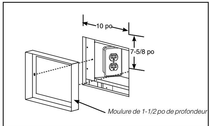
12. Attacher le boîtier TV à la structure d'encadrement à l'aide de 2 vis de chaque côté. Voir schéma ci-dessous.
