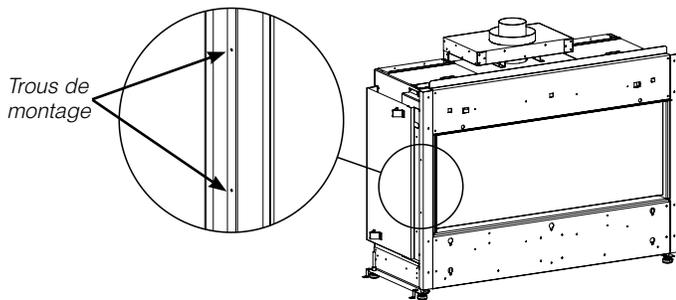
3. Fixer les panneaux de la base de gauche et de droite à l'aide de 2 vis de chaque côté.
