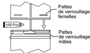
**REMARQUE : Pour de meilleurs résultats et une performance optimale d'un système d'évacuation homologué, il est vivement recommandé d'appliquer du scellant Mill-Pac (fourni) sur la partie intérieure de chaque raccord de conduit. Le non-respect de cette procédure peut causer des problèmes de tirage et de performance qui ne sont pas couverts par la garantie.**
