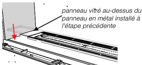
7. Installer une des fixations du panneau du fond avec une vis sans la serrer (ne pas serrer la fixation pour laisser suffisamment d'espace pour installer le panneau du fond à l'arrière).
