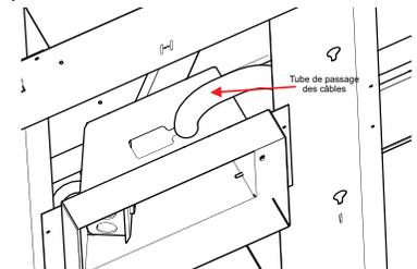
8. Fixer le tube pour le passage des câbles à l'intérieur de la structure à l'aide des attaches fournies.
