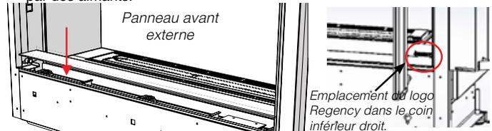
14. Installer les panneaux latéraux externes (8, 9) — ces panneaux sont maintenus par des aimants. Nettoyer toutes les traces de doigt sur les panneaux externe et inférieur avant de passer à l'étape suivante.
