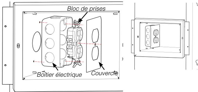
5. Faire courir le câble BX de l'arrière du boîtier électrique à travers la structure de montage en utilisant les attaches fournies (utiliser les trous les plus larges de la structure pour faire passer les attaches des câbles).
