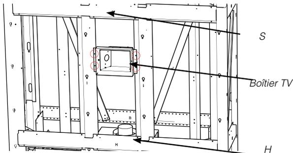
2. Installer le boîtier électrique dans le boîtier de la TV à l'aide de 2 vis—voir plus bas.
