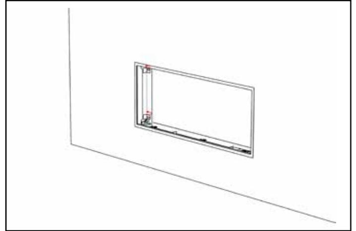
2. Avant d'installer les panneaux de la doublure extérieure et l'écran vitré, retirer les plaques de la garniture de finition des deux côtés du foyer.
