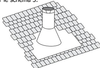
Schéma 3 : installer la portion supérieure du solin au-dessous des matériaux de toiture et ne pas la fixer avant l'installation du conduit de cheminée. De petits ajustements pourront ainsi être effectués par la suite.
