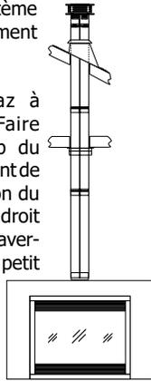
2. Placer l'appareil au gaz à l'emplacement désiré. Faire descendre un fil à plomb du plafond jusqu'à l'emplacement de la sortie (buse) d'évacuation du foyer. Tracer au plafond l'endroit où le conduit d'évacuation traversera le plafond. Percer un petit trou à cet endroit. Ensuite, faire descendre un fil à plomb du toit jusqu'au trou percé précédemment dans le plafond. Marquer l'endroit où le conduit d'évacuation traversera le toit.
