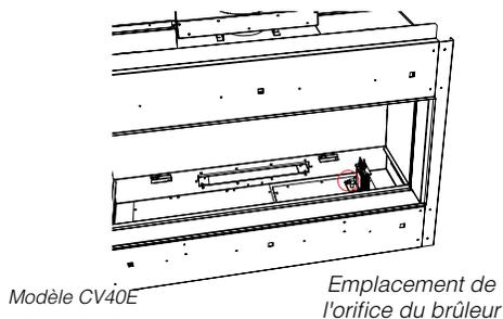
13. Retirer la pince de retenue de la veilleuse à l'aide d'une paire de tenailles et enlever la coiffe de la veilleuse pour dégager l'orifice de la veilleuse.
