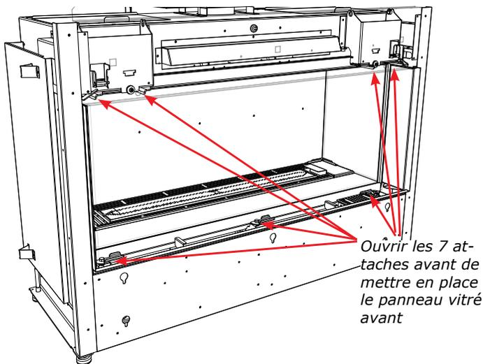
4. Soulever le panneau avant à l'aide des ventouses fournies et le mettre en place dans la rainure avant inférieure – s'assurer que le panneau avant est correctement centré. Une fois en place, fixer le panneau en fermant les 3 attaches inférieures et les 4 supérieures.
