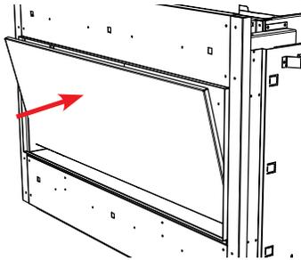
3. Installer la fixation du panneau dans la rainure sur le panneau.
