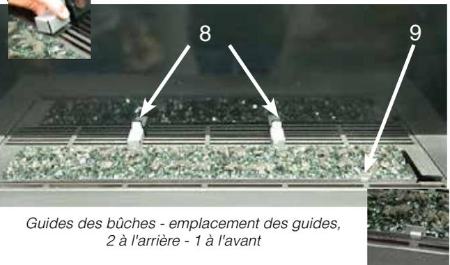
Guides des bûches - emplacement des guides, 2 à l'arrière - 1 à l'avant
