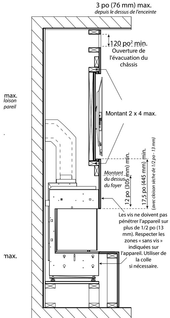
Encastrement TV affleurant au mur avec une cloison sèche de 1/2 po (13 mm)
