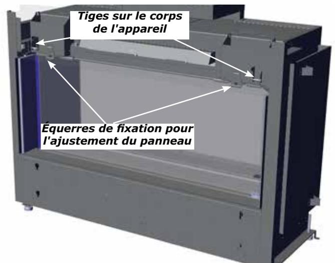
**Remarque :** Si les panneaux vitrés extérieurs de sécurité ne sont pas à 90° et sont inclinés trop à l'avant ou à l'arrière, retirer le panneau et régler la vis de l'équerre de fixation du panneau. Tourner cette vis en procédant par 1/4 de tour - réinstaller le panneau pour vérifier qu'il est bien droit.
