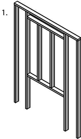
Ouverture de la structure d'encadrement pour l'évacuation
