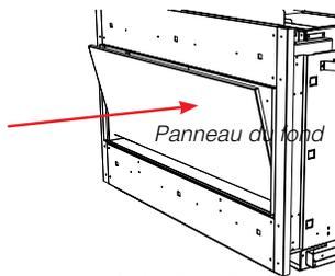
4. Une fois le panneau du fond en place — installer le panneau latéral. Monter la fixation du panneau dans la rainure située en haut du panneau. Placer le panneau muni de la fixation dans l'appareil, contre la paroi latérale. Glisser la fixation (installée sur le panneau) par-dessus la vis dans l'appareil pour fixer le panneau latéral.
