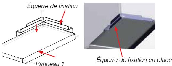
5. Installer le panneau en métal (3) dans le panneau avant de la chambre de combustion.
