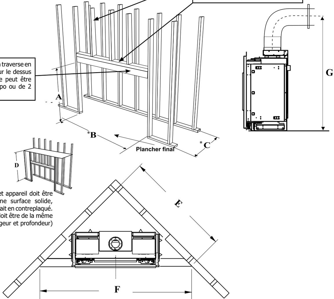
Remarque : Cet appareil doit être installé sur une surface solide, comme un sol fait en contreplaqué. Cette surface doit être de la même dimension (largeur et profondeur) que l'appareil.
