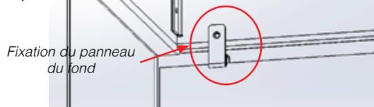
8. Placer avec précaution le panneau vitré du fond (4) à la paroi du fond de la chambre de combustion. Centrer le panneau vitré au fond de la chambre de combustion en le plaçant sous la fixation desserrée — une fois en place, glisser la fixation dans son emplacement de l'autre côté et serrer les 2 fixations à l'aide d'une vis chacune.
