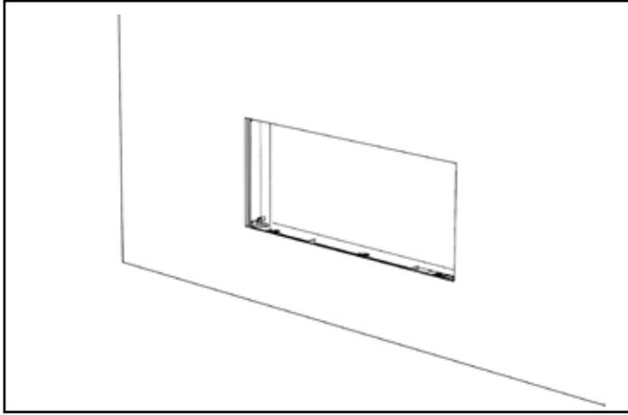
4. Plier à la main les languettes de fixation pour qu'elles dépassent les aimants et atteignent la paroi métallique à l'intérieur de l'ouverture.
