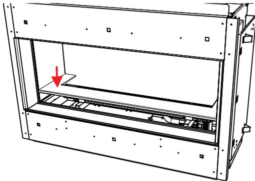
3. Installer le panneau noir en émail - manoeuvrer le panneau dans l'appareil et le placer sur la paroi du fond de la chambre de combustion.
