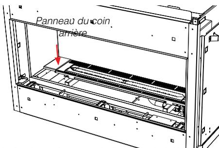
4. Installer la fixation qui permet de fixer le coin inférieur, comme montré ci-dessous. Répéter cette étape pour la fixation de l'autre côté.
