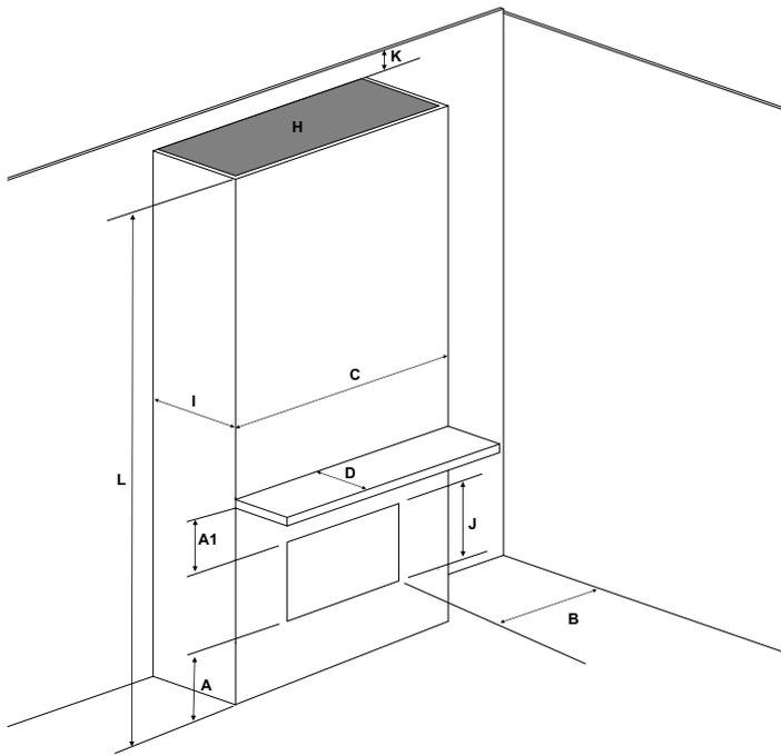
Du plancher vers le plafond avec ouverture supérieure de ventilation
