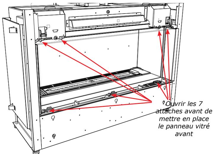
4. Soulever le panneau avant à l'aide des ventouses fournies et le mettre en place dans la rainure avant inférieure – s'assurer que le panneau avant est correctement centré. Une fois en place, fixer le panneau en fermant les 3 attaches inférieures et les 4 supérieures.
