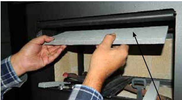
Défecteur du centre
